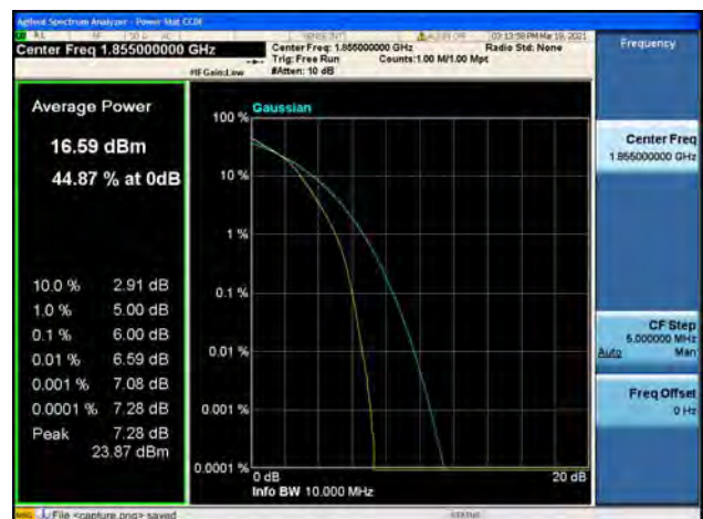
Band2 / 10MHz / Low CH / 64QAM
