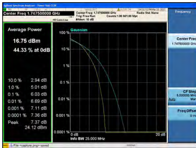
Band4 / 20MHz / Low CH / 16QAM
