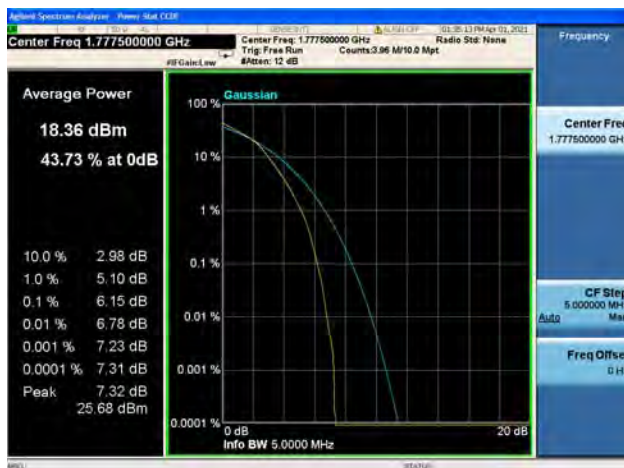
Band66 / 10MHz / Low CH / 16QAM
