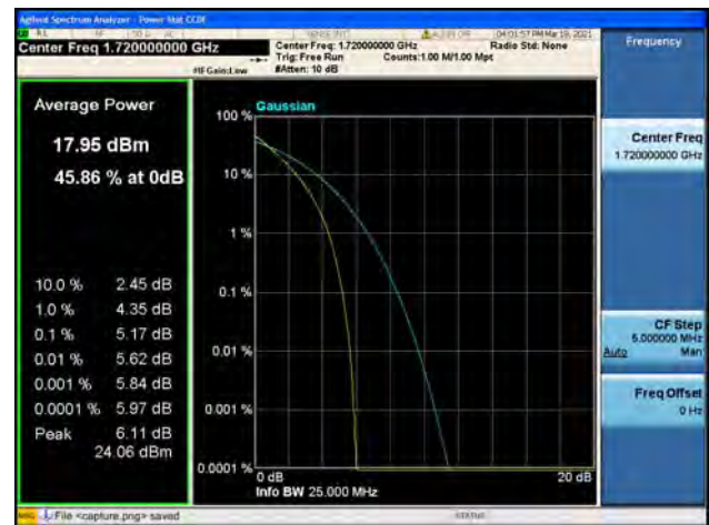
Band4 / 20MHz / Low CH / 64QAM
