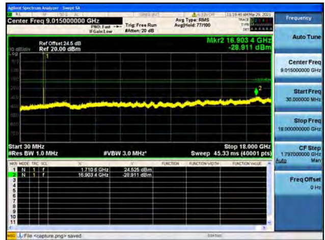
Band4 / 5MHz / Mid CH / QPSK
