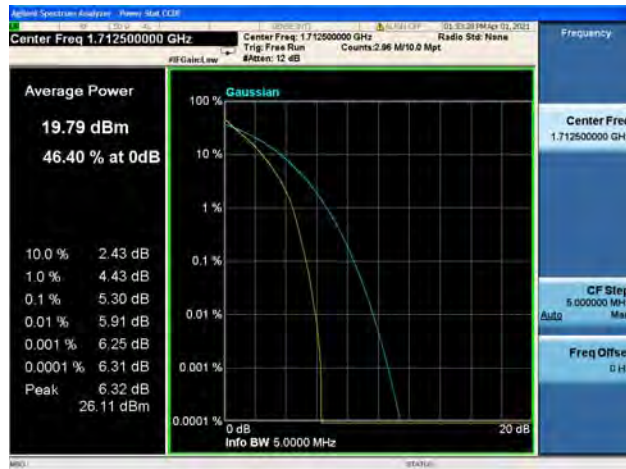
Band66 / 5MHz / Low CH / 64QAM
