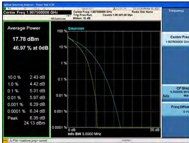
Band2 / 5MHz / High CH / 64QAM
