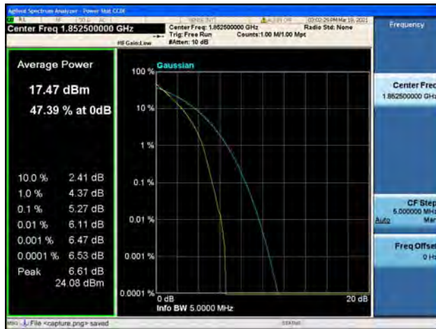
Band2 / 5MHz / Low CH / 64QAM
