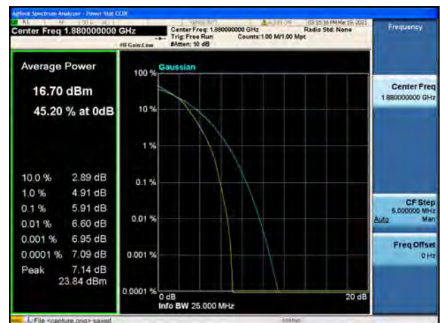
Band2 / 15MHz / Mid CH / 64QAM
