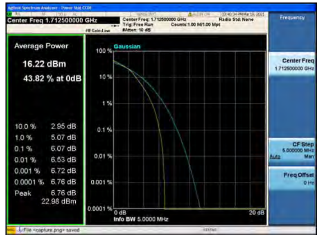
Band4 / 5MHz / Mid CH / QPSK
