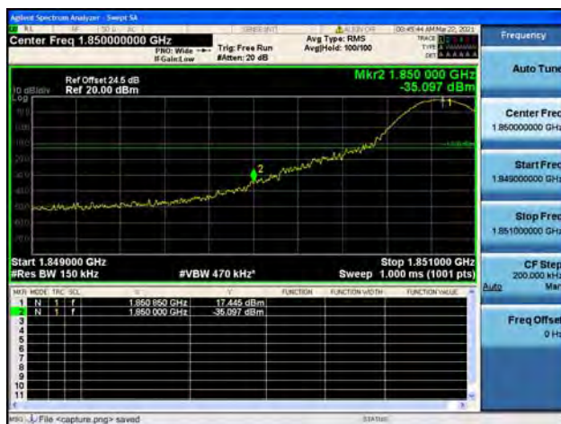
Band2 / 15MHz / Low CH / QPSK / 1 RB
