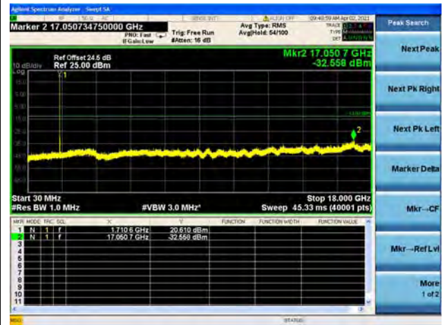
Band66 / 1.4MHz / Mid CH / QPSK
