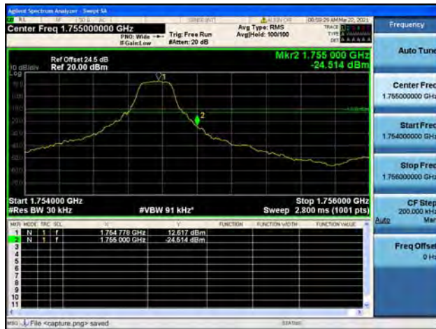
Band4 / 5MHz / Low CH / QPSK / 1 RB
