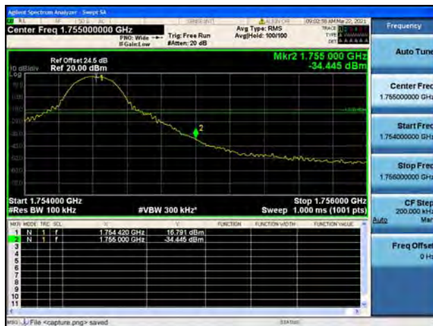
Band4 / 15MHz / Low CH / QPSK / 1 RB
