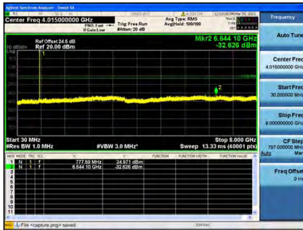
Band13 / 5MHz / Low CH / 64QAM
