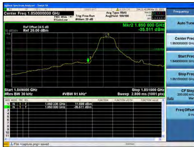
Band2 / 1.4MHz / High CH / QPSK / 1 RB
