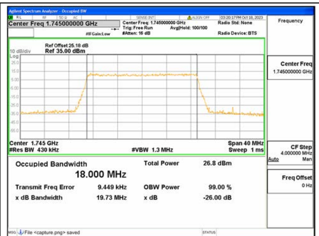
B66 / 20MHz / 256QAM/ Mid CH
