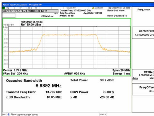
B66 / 10MHz / QPSK/ Mid CH
