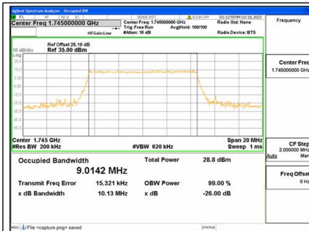
B66 / 10MHz / 64QAM/ Mid CH
