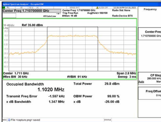
B66 / 1.4MHz / 64QAM / Low CH
