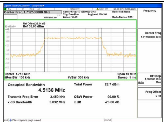
B66 / 5MHz / 16QAM/ Low CH
