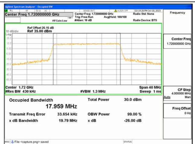
B66 / 20MHz / 16QAM/ Low CH
