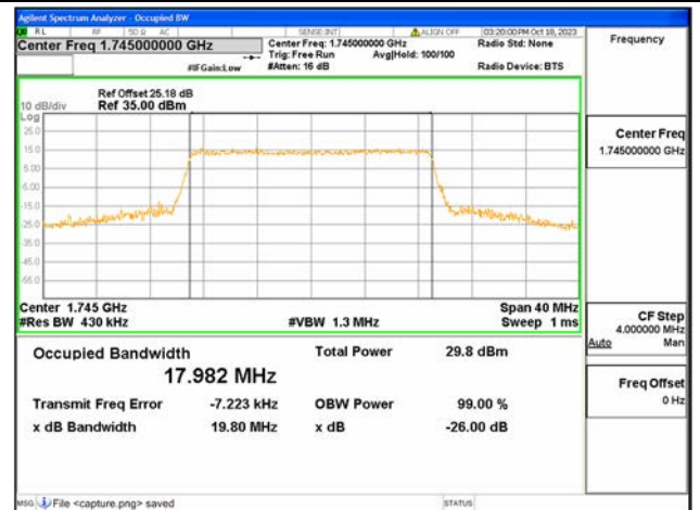
B66 / 20MHz / 16QAM/ Mid CH
