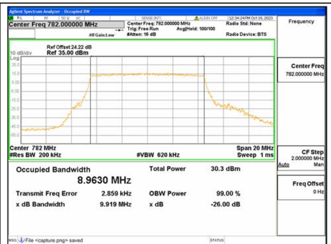
B13 / 10MHz / 16QAM / Mid CH
