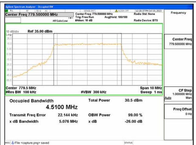
B13 / 5MHz / 16QAM/ Low CH
