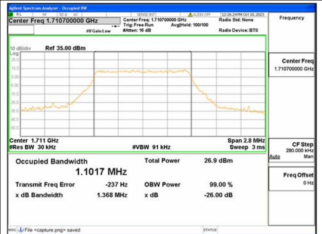
B66 / 1.4MHz / 256QAM / Low CH
