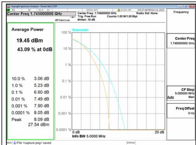
B66 / 5MHz / Mid CH / 64QAM
