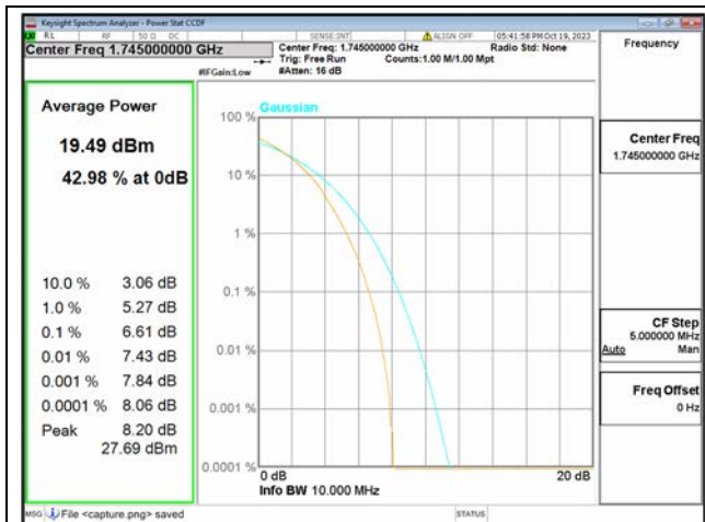
B66 / 10MHz / Mid CH / 64QAM
