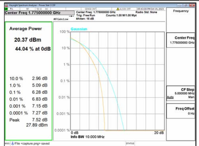
B66 / 10MHz / High CH / 16QAM
