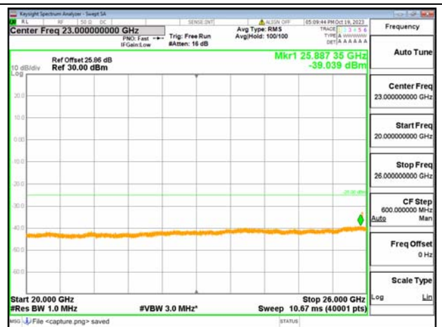
B7-20G-26G / 20MHz / Low CH / QPSK
