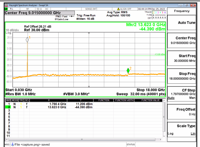
66B / 5+10MHz / QPSK / High CH / 1@0-1@49
