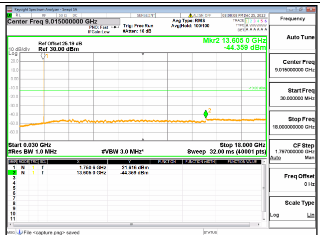
66C / 10+20MHz / QPSK / Mid CH / 1@49-1@0
