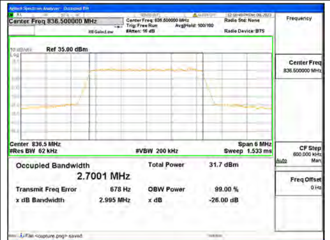
B5 / 3MHz / QPSK/ Mid CH
