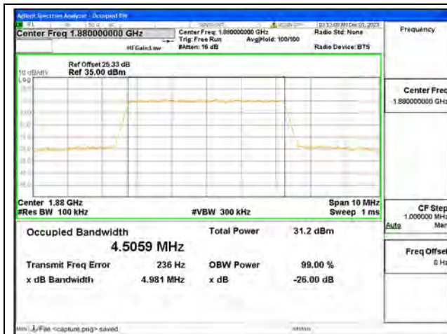
B2 / 5MHz / QPSK/ Mid CH
