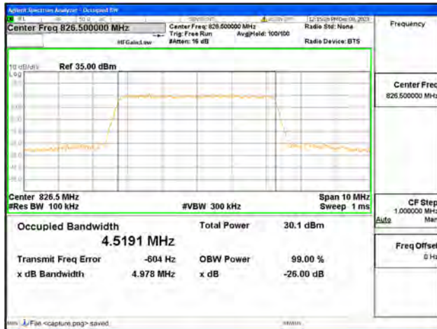
B5 / 5MHz / 64QAM/ Low CH
