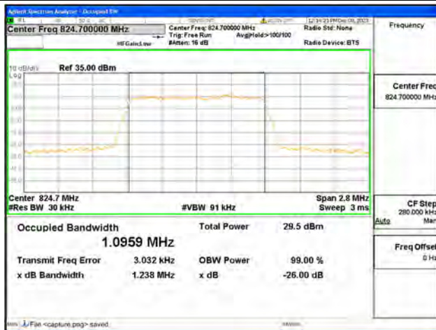
B5 / 1.4MHz / 64QAM/ Low CH
