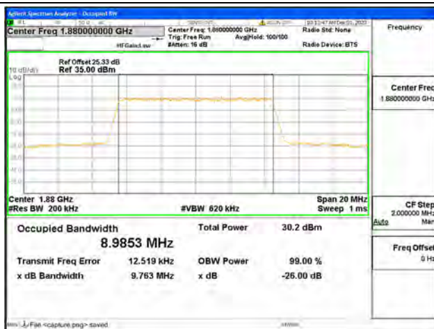
B2 / 10MHz / 16QAM/ Mid CH
