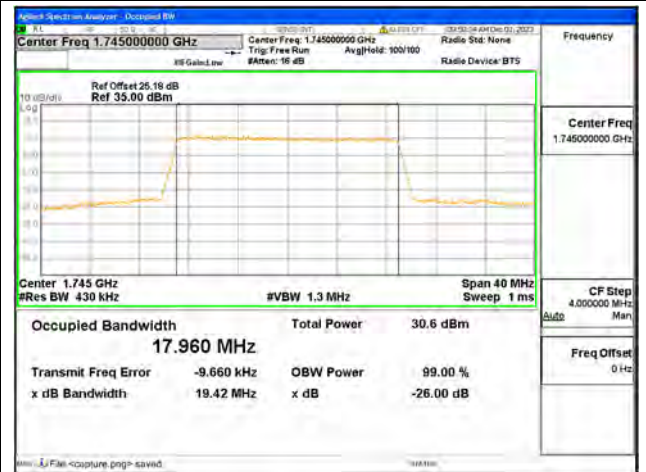
B66 / 20MHz / QPSK/ Mid CH
