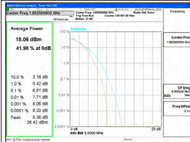
B2 / 5MHz / Low CH / 64QAM
