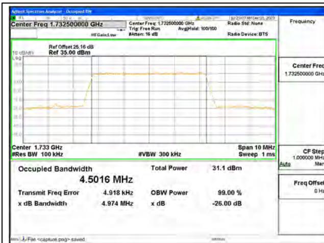
B4 / 5MHz / QPSK/ Mid CH
