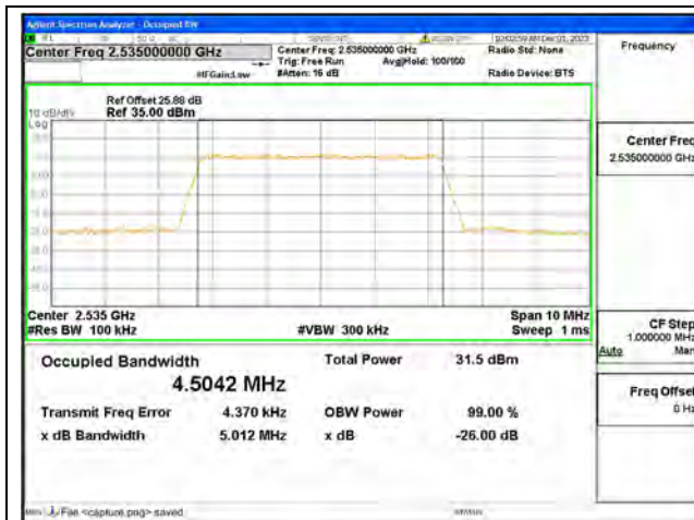
B7 / 5MHz / QPSK/ Mid CH
