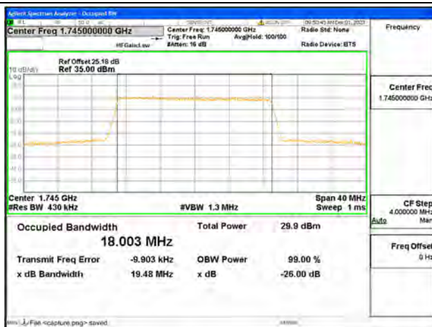
B66 / 20MHz / 16QAM/ Mid CH
