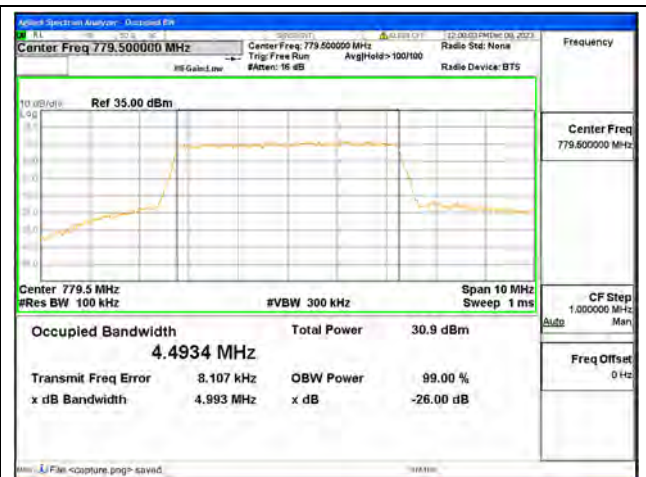
B13 / 5MHz / 16QAM/ Low CH
