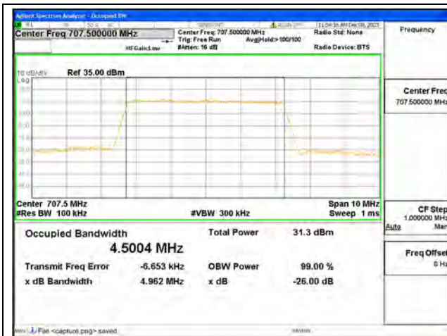
B12 / 5MHz / QPSK / Mid CH
