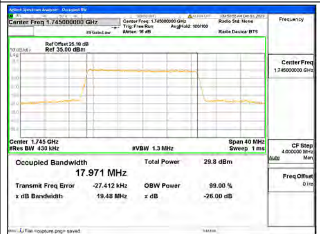
B66 / 20MHz / 64QAM/ Mid CH
