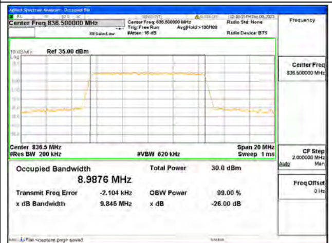
B5 / 10MHz / 64QAM / Mid CH
