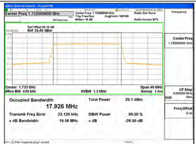
B4 / 20MHz / 64QAM/ Mid CH
