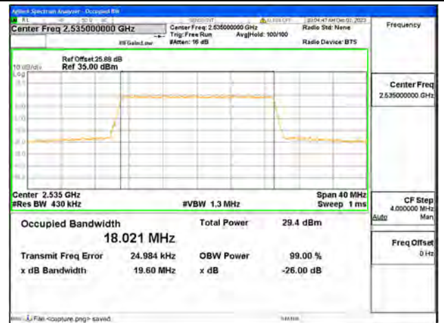
B7 / 20MHz / 64QAM/ Mid CH
