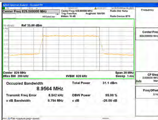
B5 / 10MHz / 16QAM/ Low CH
