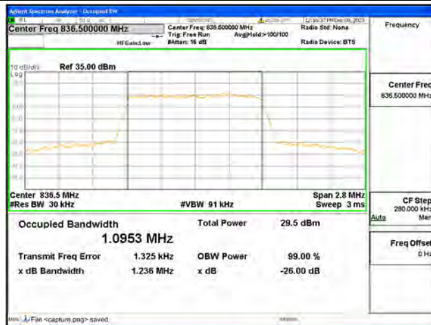
B5 / 1.4MHz / 64QAM/ Mid CH
