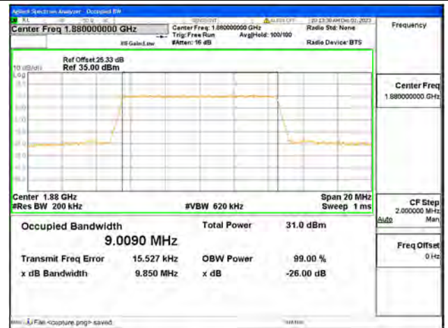
B2 / 10MHz / QPSK/ Mid CH
