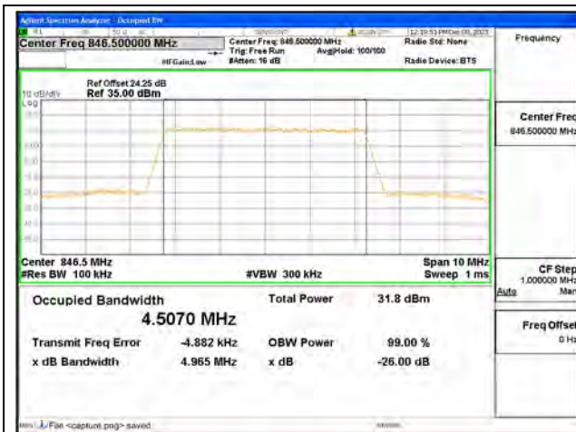
B5 / 5MHz / QPSK/ High CH
