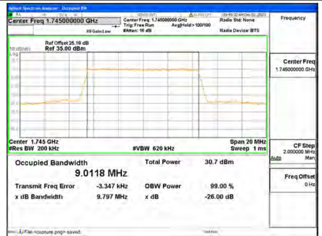
B66 / 10MHz / QPSK/ Mid CH
