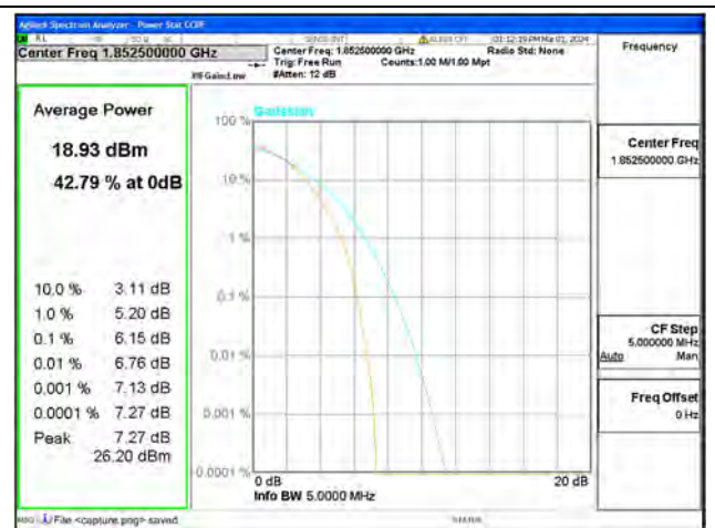
B2 / 5MHz / Low CH / 16QAM
