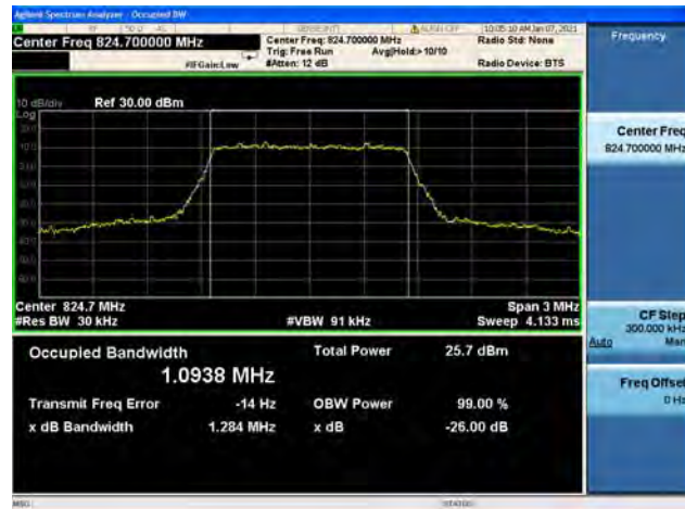
Band26 / 1.4MHz / Low CH / 64QAM
