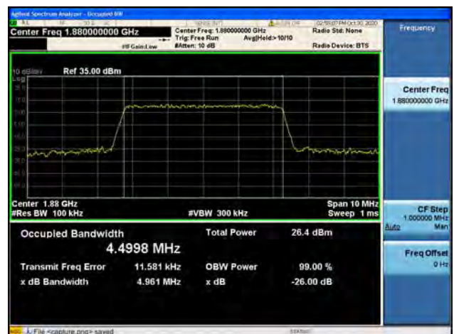
Band2 / 5MHz / Mid CH / 64QAM
