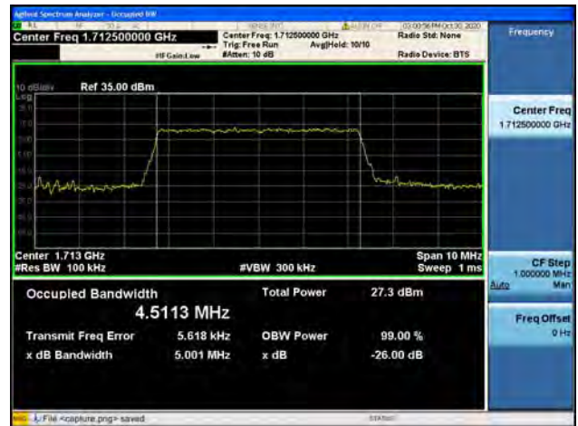
Band4 / 5MHz / Mid CH / QPSK
