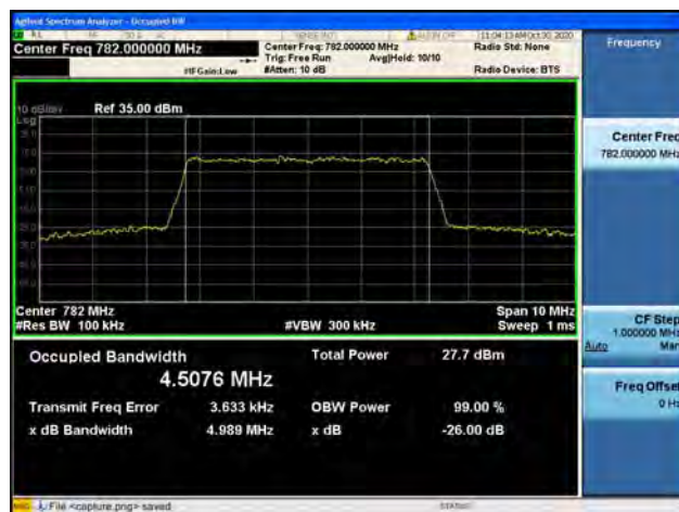
Band13 / 5MHz / Mid CH / 16QAM
