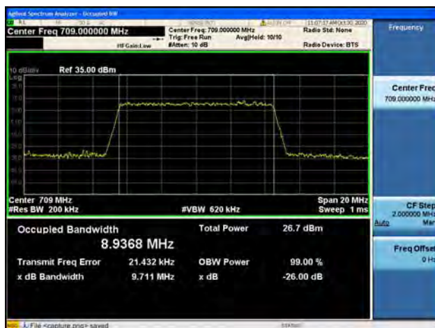
Band17 / 10MHz / Low CH / 16QAM
