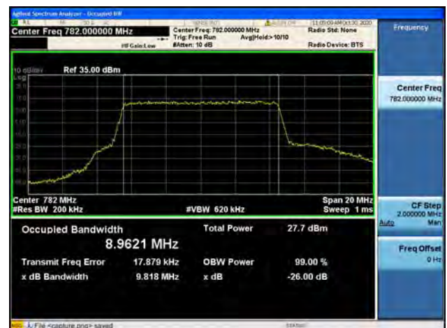
Band13 / 10MHz / Low CH / 64QAM
