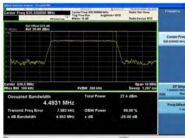
Band26 / 5MHz / Mid CH / 16QAM
