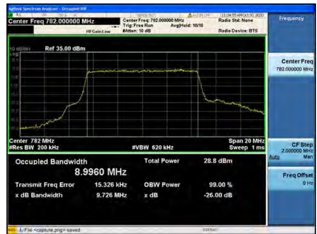
Band13 / 10MHz / Low CH / 64QAM
