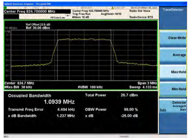
Band26 / 1.4MHz / Mid CH / QPSK
