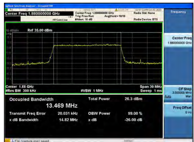
Band2 / 15MHz / Mid CH / 64QAM
