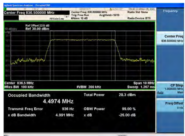
Band26 / 5MHz / Mid CH / 64QAM
