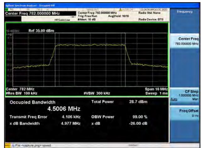
Band13 / 5MHz / Mid CH / 64QAM
