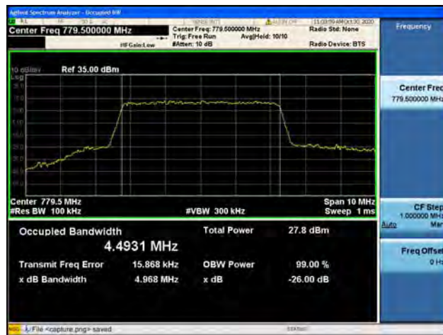
Band13 / 5MHz / Mid CH / 16QAM
