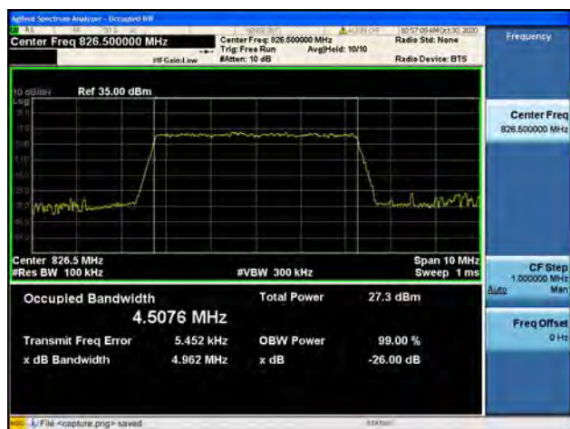
Band5 / 5MHz / Mid CH / QPSK
