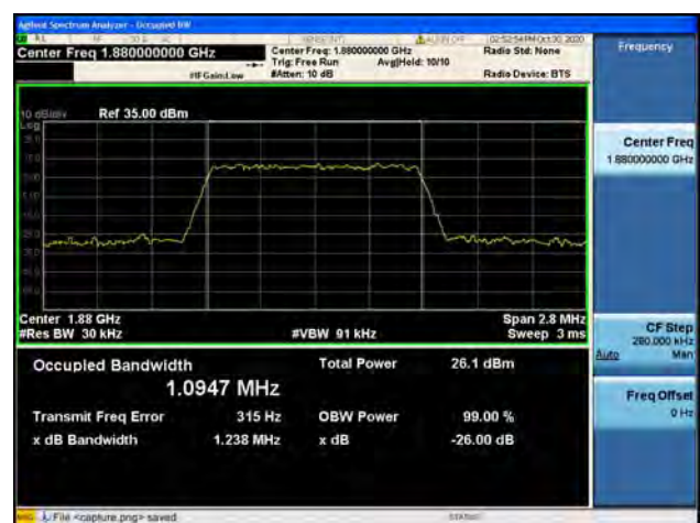
Band2 / 1.4MHz / Mid CH / 64QAM
