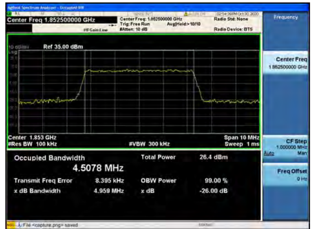
Band2 / 5MHz / Mid CH / QPSK
