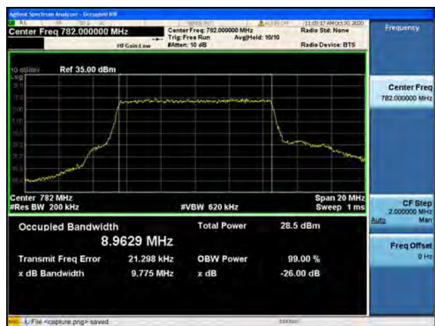
Band13 / 10MHz / Mid CH / 64QAM
