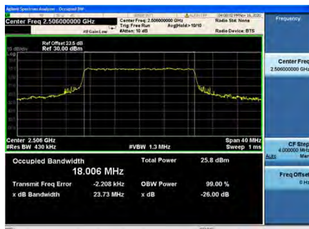
Band41 / 20MHz / Low CH / 16QAM
