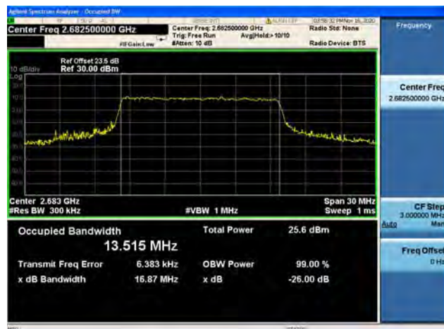
Band41 / 20MHz / Low CH / 16QAM
