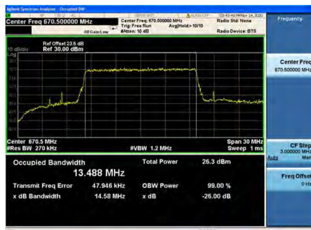
Band71 / 15MHz / Mid CH / 16QAM
