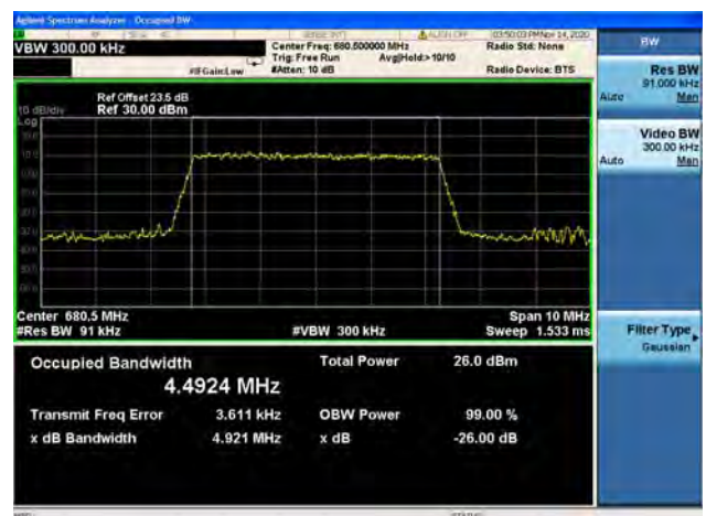
Band71 / 5MHz / Mid CH / 64QAM
