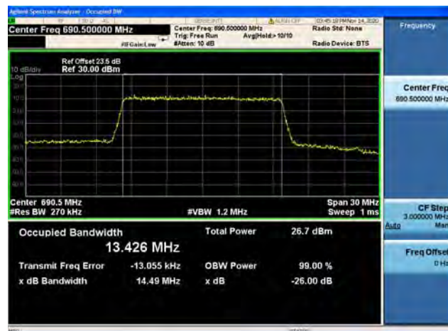
Band71 / 20MHz / Low CH / 16QAM
