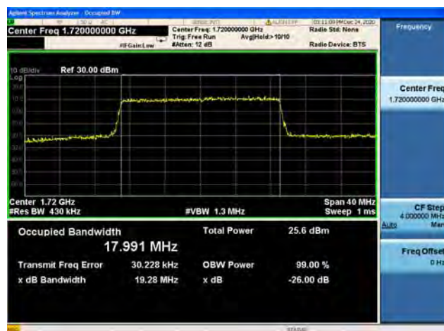
Band66 / 20MHz / Low CH / 16QAM
