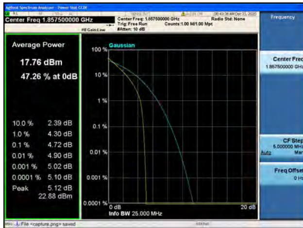
Band2 / 15MHz / Low CH / 64QAM
