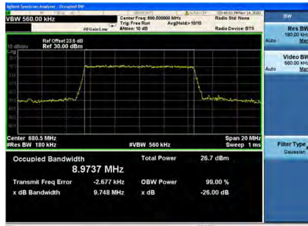
Band71 / 10MHz / Mid CH / 64QAM
