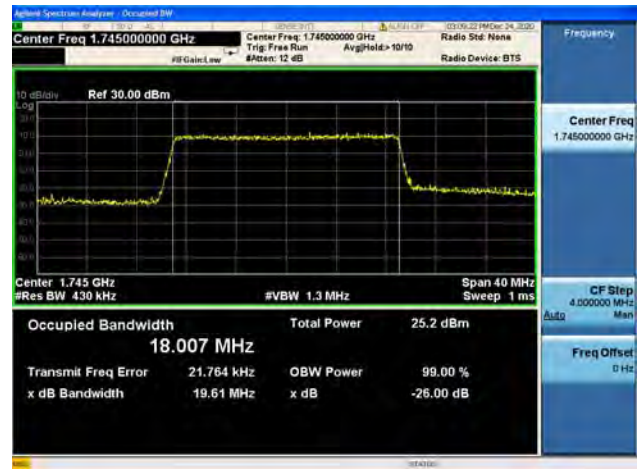
Band66 / 20MHz / High CH / QPSK
