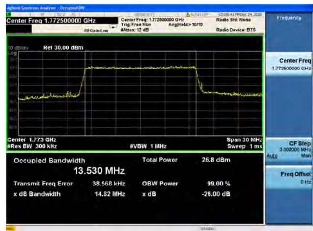
Band66 / 20MHz / Low CH / QPSK
