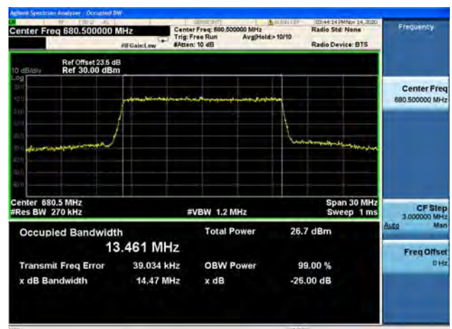
Band71 / 15MHz / Mid CH / 64QAM
