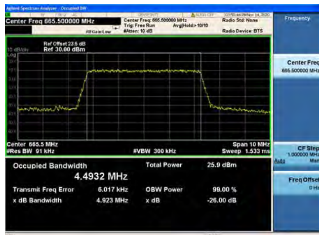
Band71 / 5MHz / Mid CH / 16QAM
