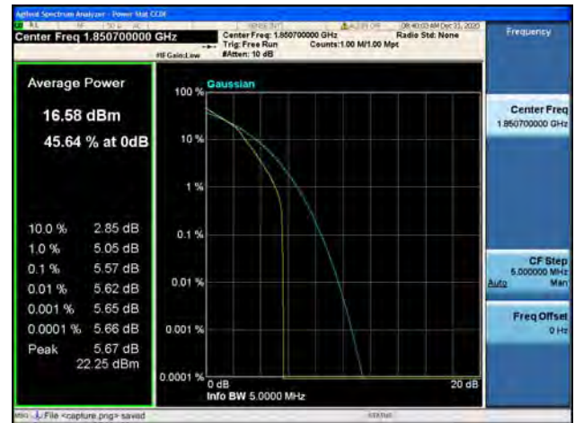
Band2 / 1.4MHz / Mid CH / QPSK
