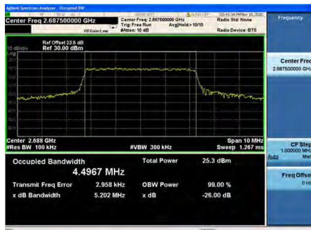
Band41 / 10MHz / Low CH / 16QAM
