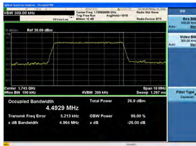
Band66 / 5MHz / Low CH / 64QAM
