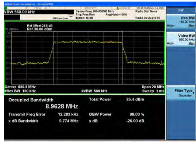
Band71 / 10MHz / High CH / QPSK
