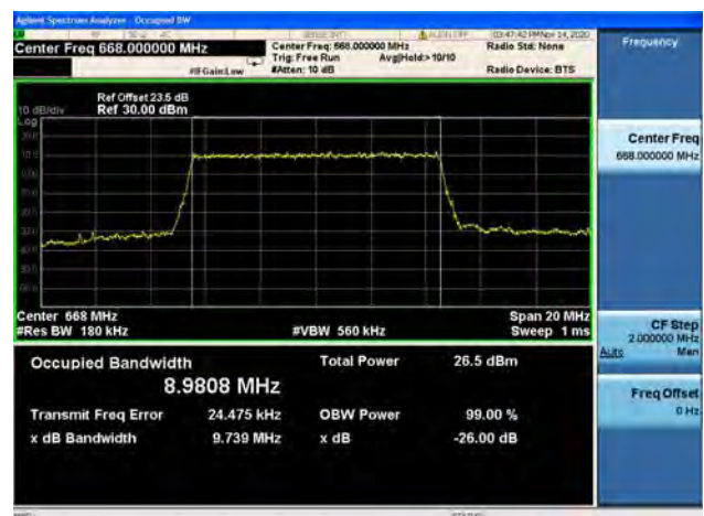
Band71 / 10MHz / Low CH / 64QAM
