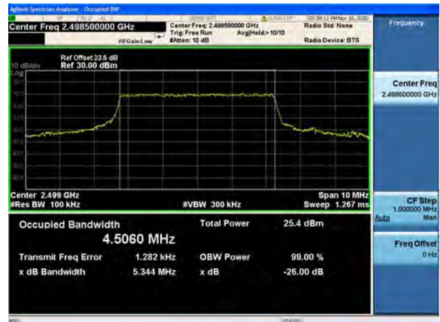
Band41 / 5MHz / Mid CH / QPSK
