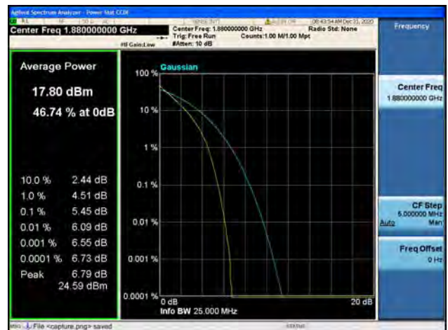
Band2 / 15MHz / Mid CH / 64QAM
