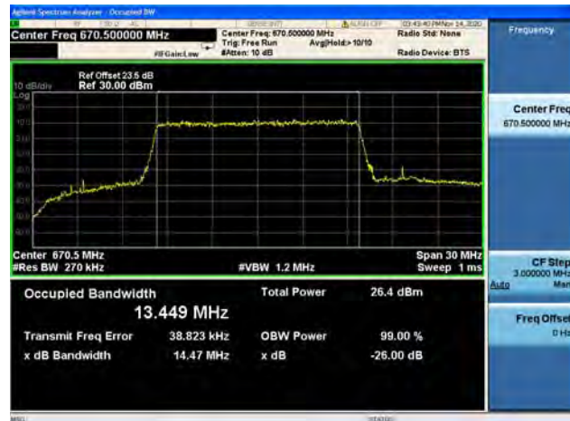
Band71 / 15MHz / Low CH / 64QAM
