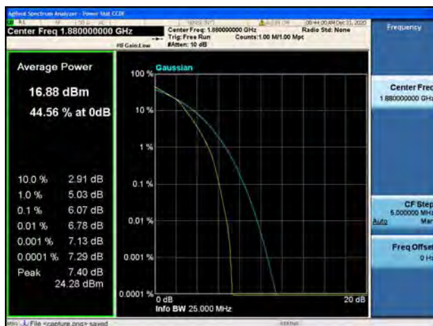
Band2 / 15MHz / Mid CH / 16QAM
