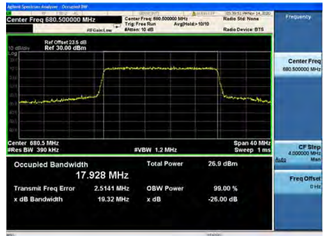
Band71 / 20MHz / High CH / QPSK
