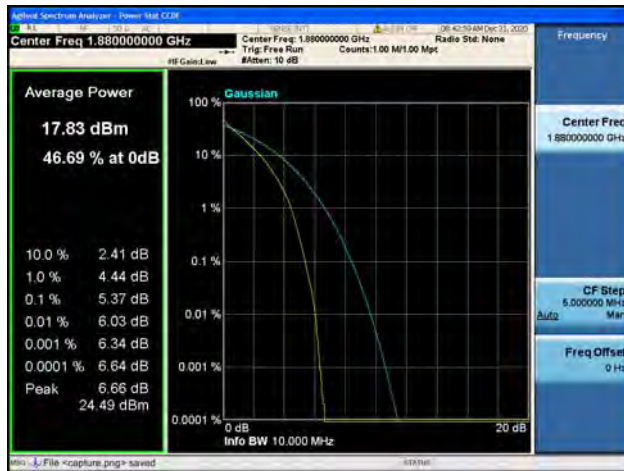
Band2 / 10MHz / Mid CH / 64QAM
