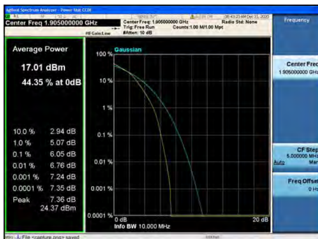
Band2 / 10MHz / High CH / 16QAM
