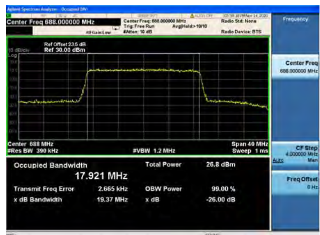
Band71 / 20MHz / High CH / 64QAM
