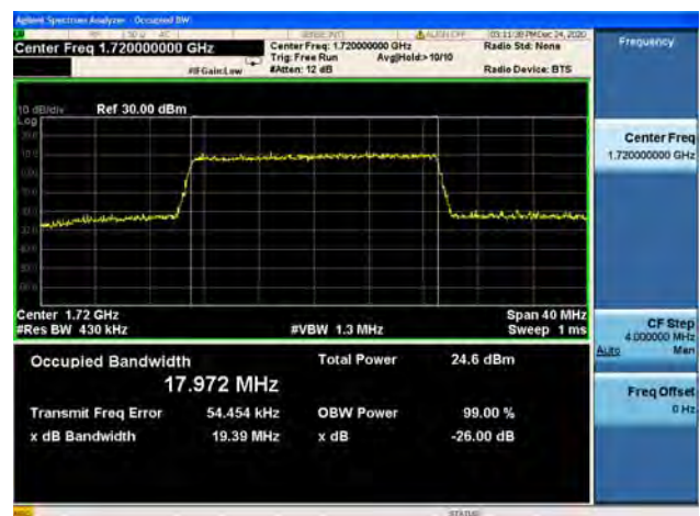
Band66 / 20MHz / Low CH / 64QAM
