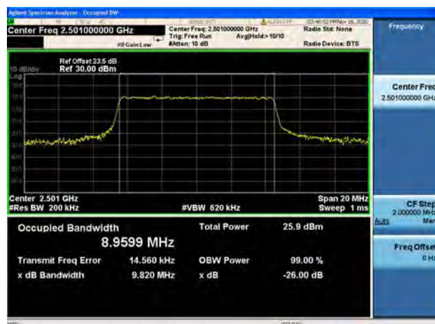
Band41 / 10MHz / Low CH / 16QAM
