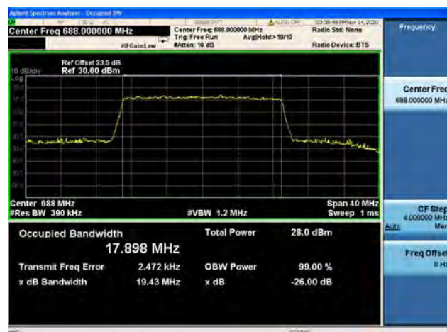
Band77 / 20MHz / High CH / 16QAM
