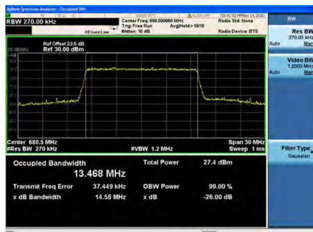
Band71 / 15MHz / Mid CH / 16QAM
