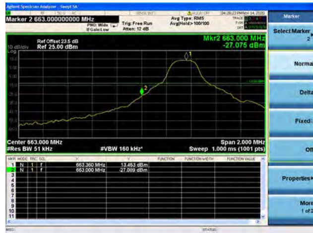
Band71 / 5MHz / High CH / QPSK / 1 RB
