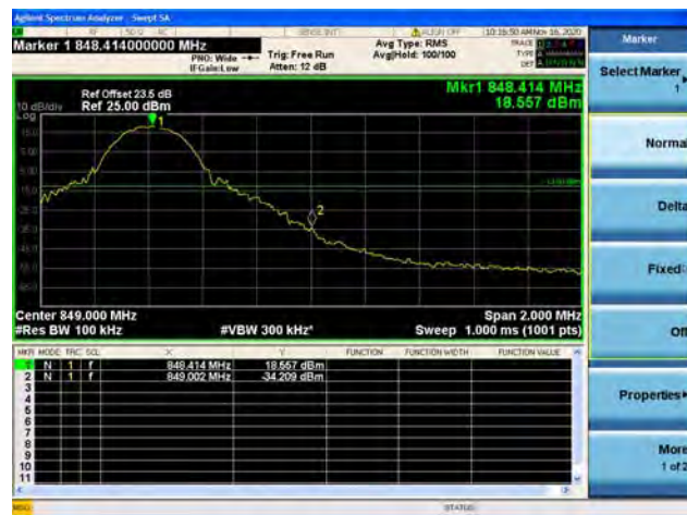
Band26 / 10MHz / High CH / QPSK / 1 RB
