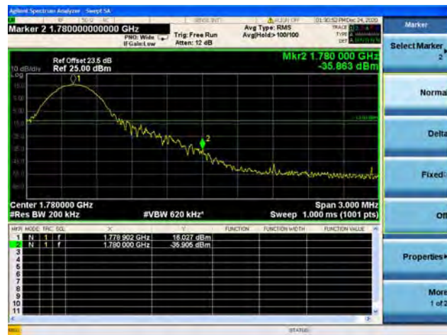
Band66 / 20MHz / High CH / QPSK / 1 RB
