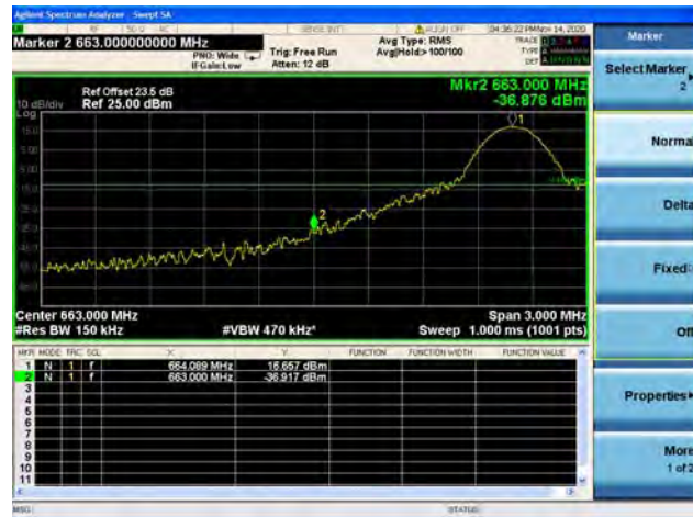
Band71 / 20MHz / High CH / QPSK / 1 RB
