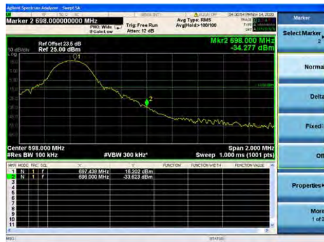
Band71 / 10MHz / High CH / QPSK / 1 RB
