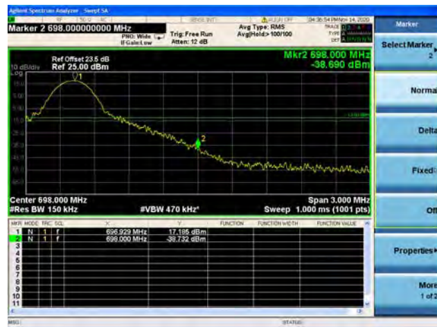
Band71 / 20MHz / High CH / QPSK / 1 RB
