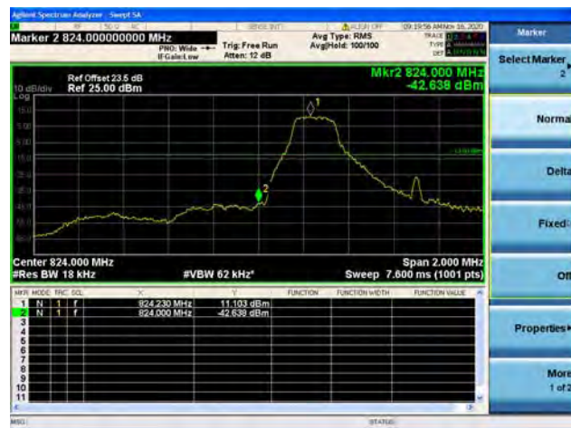
Band26 / 1.4MHz / High CH / QPSK / 1 RB
