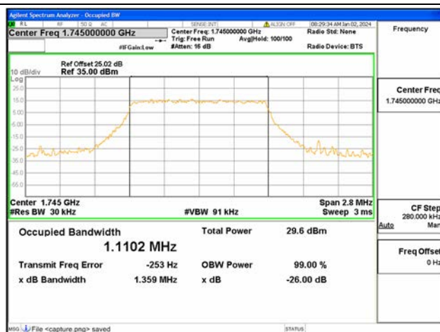
B66 / 1.4MHz / 16QAM / Mid CH
