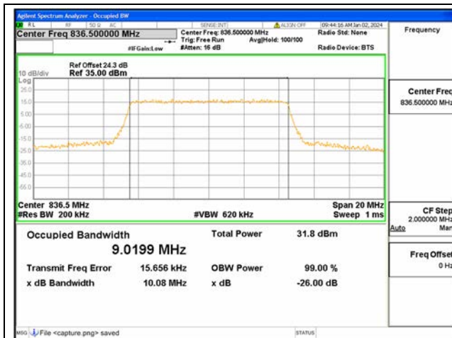
B5 / 10MHz / QPSK/ Mid CH
