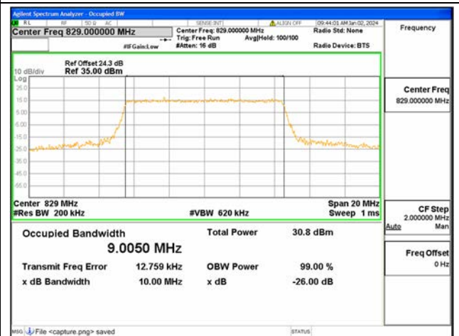
B5 / 10MHz / 64QAM/ Low CH
