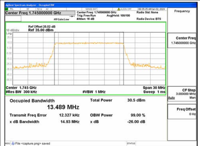
B66 / 15MHz / QPSK/ Mid CH
