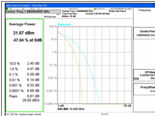
B2 / 10MHz / Mid CH / QPSK
