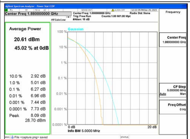
B2 / 5MHz / Mid CH / 64QAM
