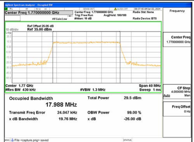
B66 / 20MHz / 64QAM / High CH
