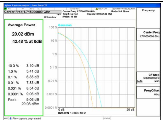
B4 / 10MHz / Low CH / 64QAM
