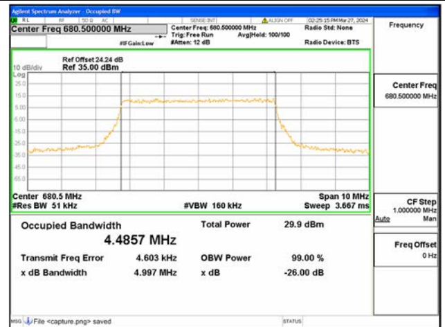
B71 / 5MHz / QPSK/ Mid CH
