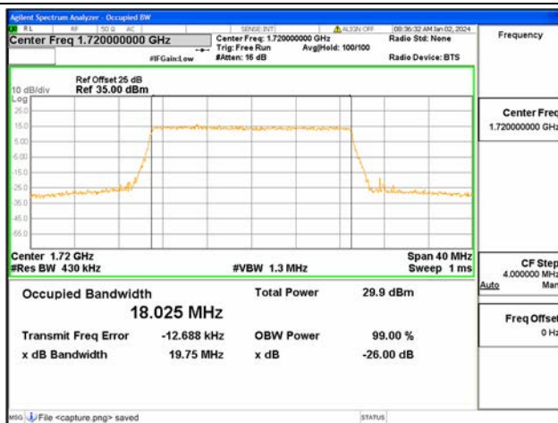
B66 / 20MHz / 16QAM/ Low CH
