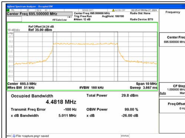
B71 / 5MHz / QPSK/ High CH
