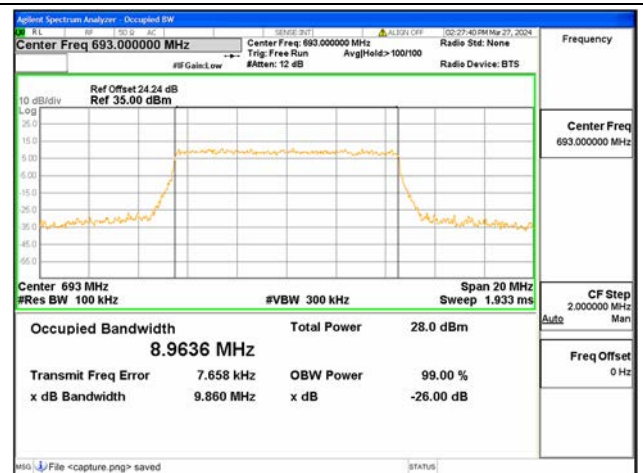
B71 / 10MHz / 64QAM / High CH
