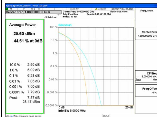
B2 / 5MHz / Mid CH / 16QAM
