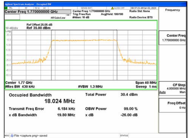
B66 / 20MHz / QPSK / High CH
