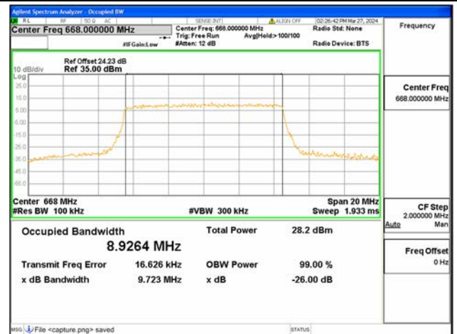
B71 / 10MHz / 64QAM/ Low CH
