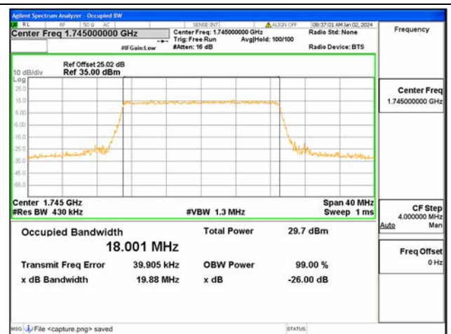
B66 / 20MHz / 16QAM / Mid CH
