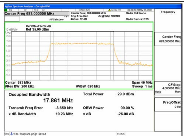
B71 / 20MHz / 16QAM / Mid CH
