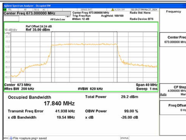
B71 / 20MHz / 16QAM/ Low CH
