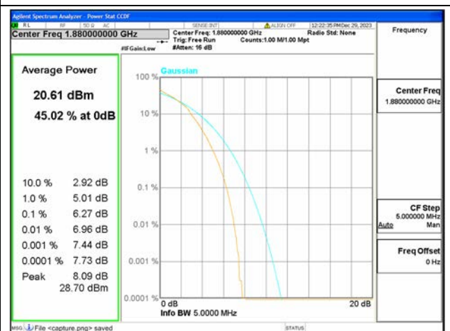
B2 / 5MHz / Mid CH / 64QAM
