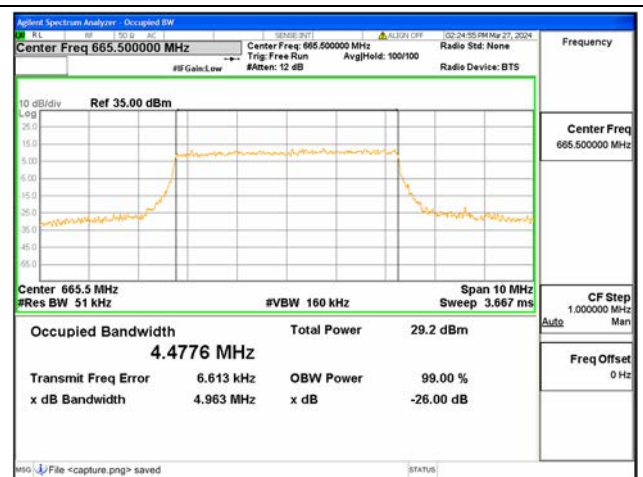
B71 / 5MHz / 16QAM/ Low CH
