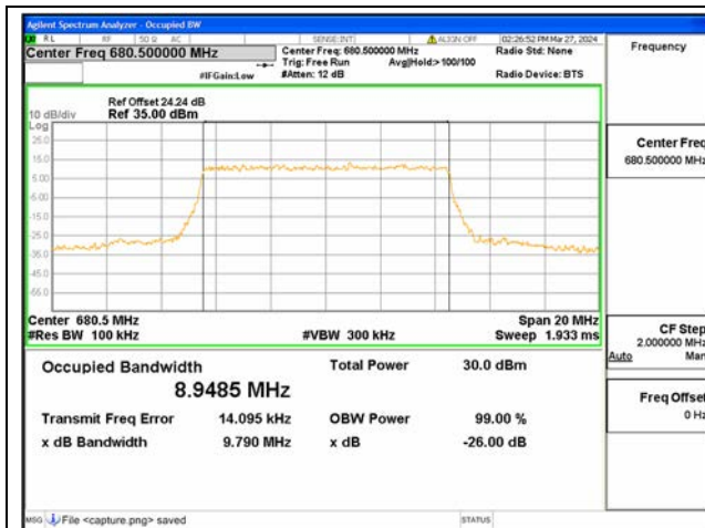
B71 / 10MHz / QPSK / Mid CH
