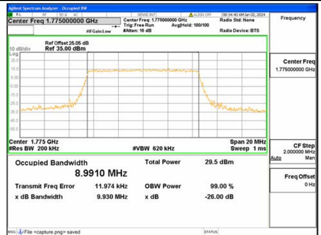
B66 / 10MHz / 64QAM / High CH
