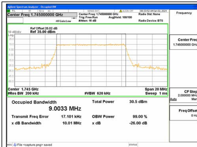
B66 / 10MHz / QPSK / Mid CH
