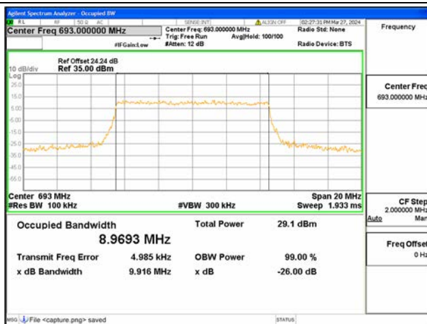
B71 / 10MHz / 16QAM / High CH
