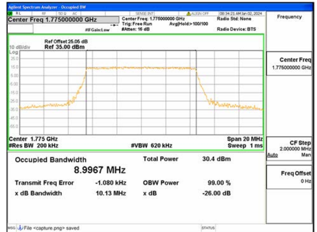
B66 / 10MHz / QPSK / High CH
