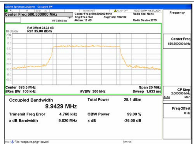
B71 / 10MHz / 16QAM / Mid CH
