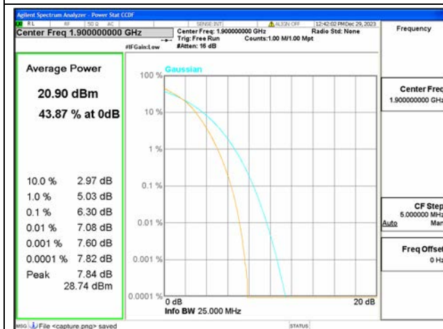
B2 / 20MHz / High CH / 16QAM
