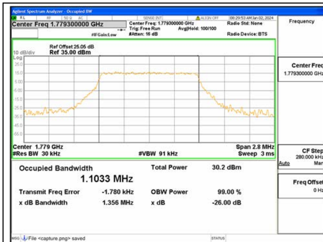
B66 / 1.4MHz / QPSK/ High CH
