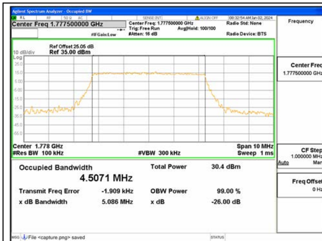
B66 / 5MHz / QPSK/ High CH
