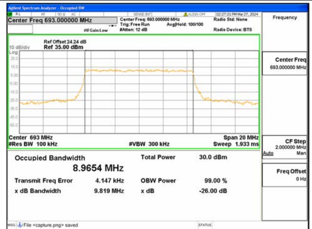
B71 / 10MHz / QPSK / High CH
