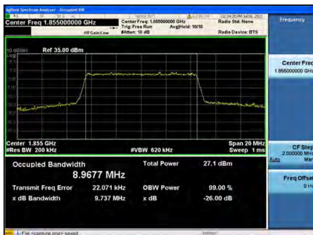
Band2 / 10MHz / Low CH / 16QAM
