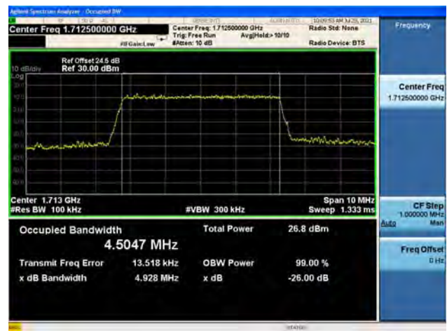
Band66 / 5MHz / Mid CH / QPSK
