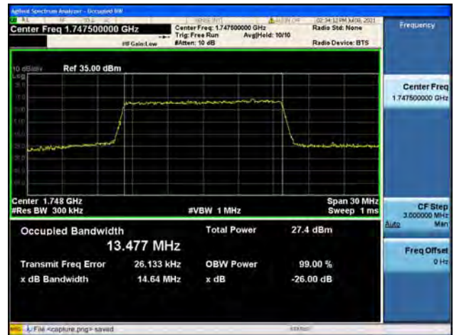
Band4 / 20MHz / Low CH / QPSK
