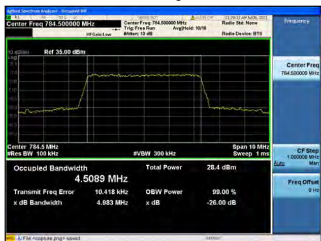
Band13 / 10MHz / Mid CH / 16QAM
