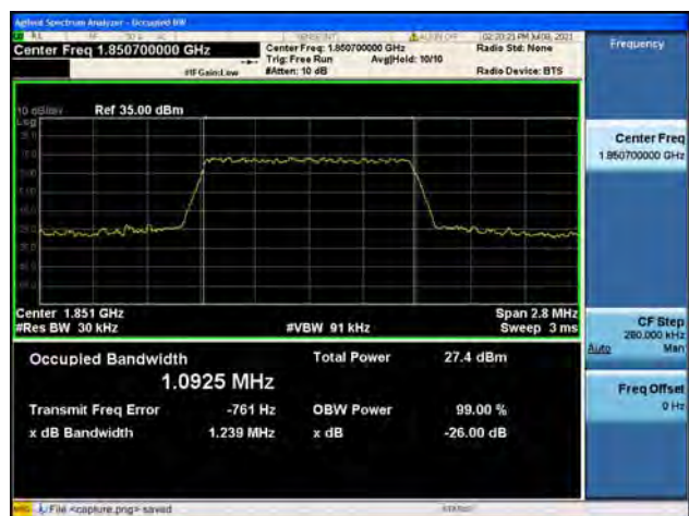
Band2 / 1.4MHz / Low CH / 64QAM
