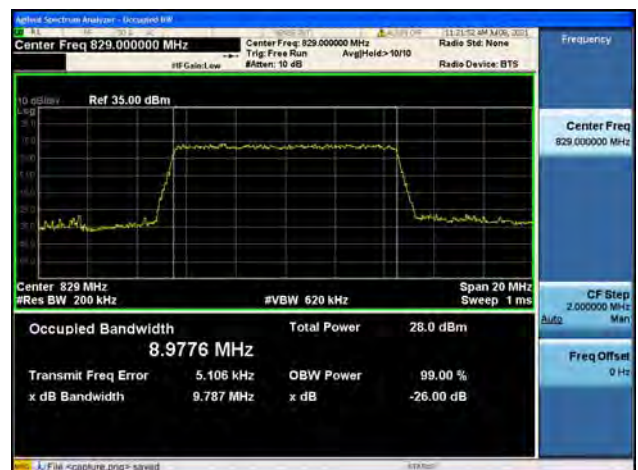
Band5 / 10MHz / Low CH / 64QAM
