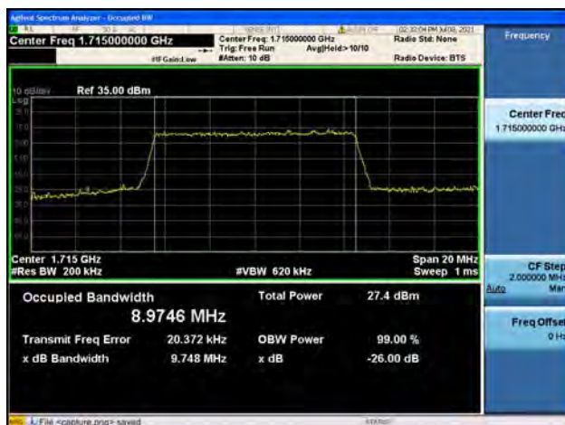
Band4 / 10MHz / Low CH / 16QAM
