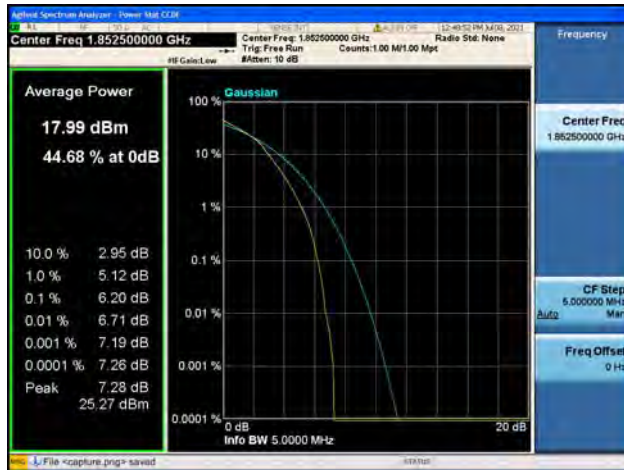
Band2 / 5MHz / Mid CH / 16QAM
