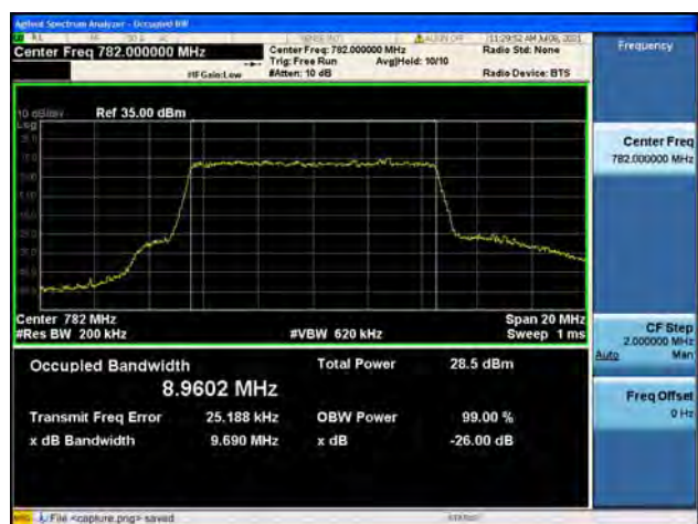
Band13 / 10MHz / Mid CH / 16QAM
