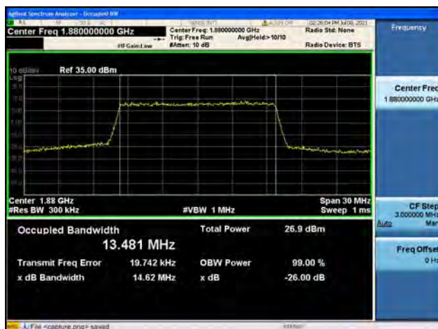
Band2 / 15MHz / Mid CH / 16QAM
