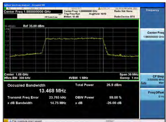
Band2 / 15MHz / Mid CH / 64QAM
