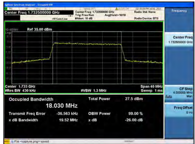
Band4 / 20MHz / High CH / QPSK
