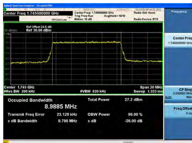
Band66 / 10MHz / Low CH / 16QAM
