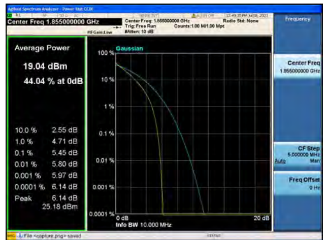
Band2 / 10MHz / Low CH / 64QAM
