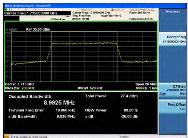
Band4 / 10MHz / Low CH / 64QAM
