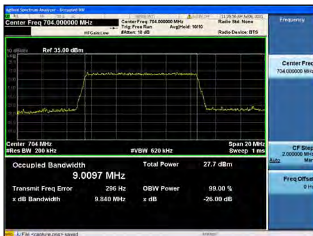
Band12 / 10MHz / Low CH / 16QAM
