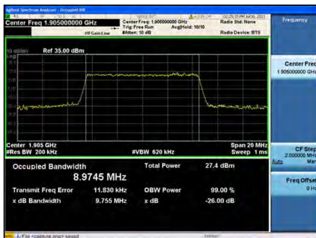
Band2 / 10MHz / High CH / 16QAM
