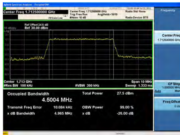
Band66 / 5MHz / Low CH / 64QAM
