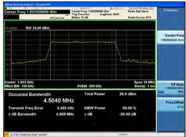
Band2 / 5MHz / Mid CH / QPSK
