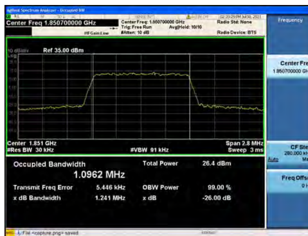
Band2 / 1.4MHz / Mid CH / QPSK
