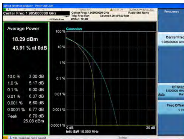
Band2 / 10MHz / High CH / 16QAM
