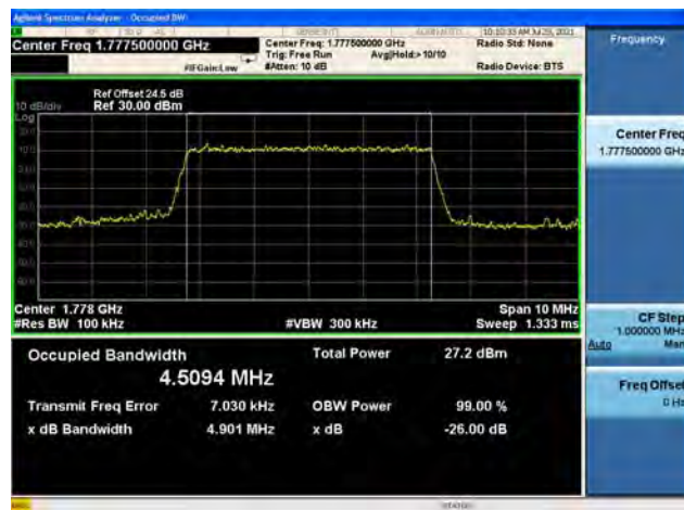
Band66 / 10MHz / Low CH / 16QAM
