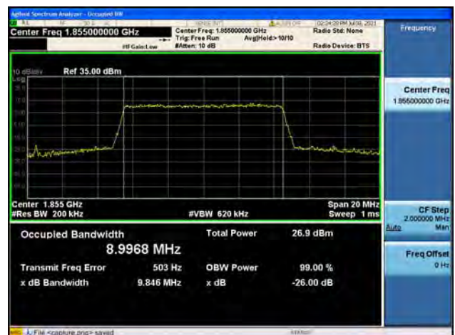
Band2 / 10MHz / Low CH / 64QAM
