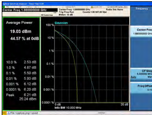
Band2 / 10MHz / Mid CH / 64QAM
