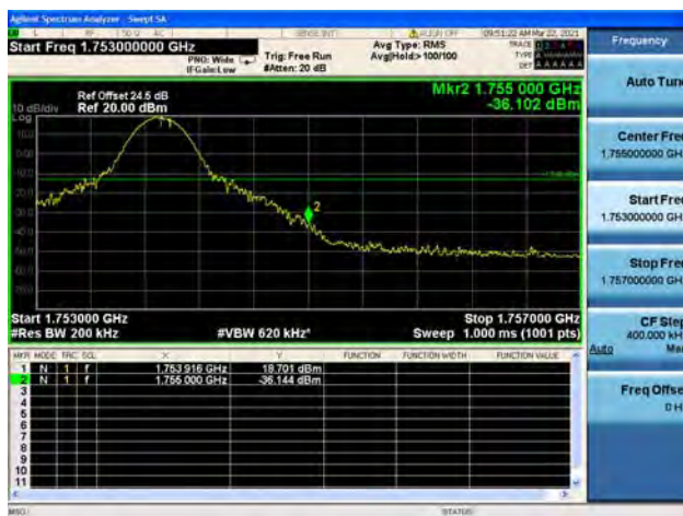
Band4 / 20MHz / High CH / QPSK / 1 RB
