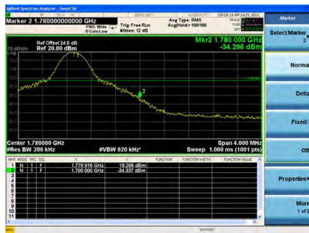
Band66 / 20MHz / High CH / QPSK / 1 RB
