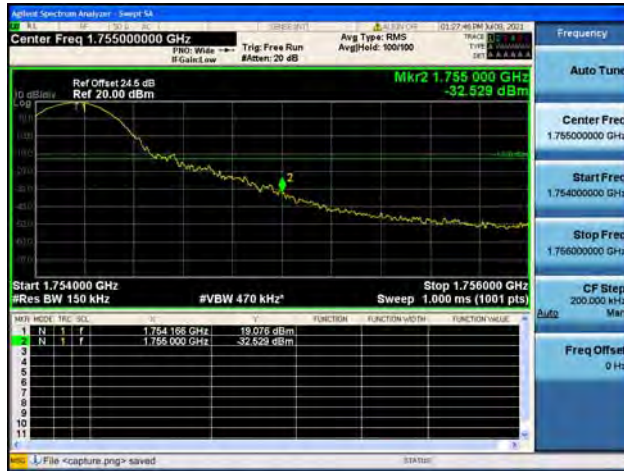
Band4 / 20MHz / Low CH / QPSK / 1 RB
