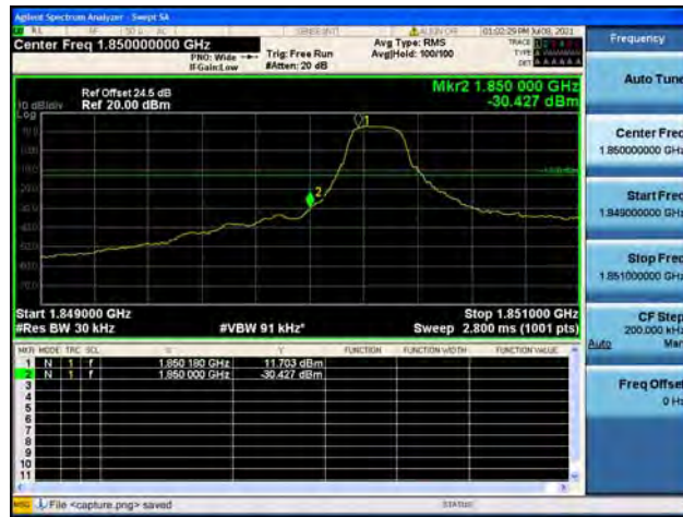
Band2 / 1.4MHz / High CH / QPSK / 1 RB
