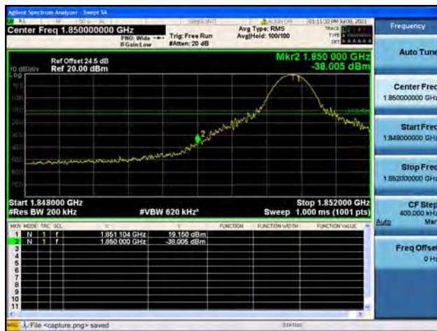
Band2 / 20MHz / High CH / QPSK / 1 RB
