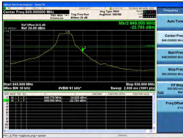
Band5 / 5MHz / Low CH / QPSK / 1 RB
