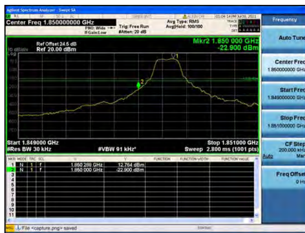
Band2 / 3MHz / Low CH / QPSK / 1 RB
