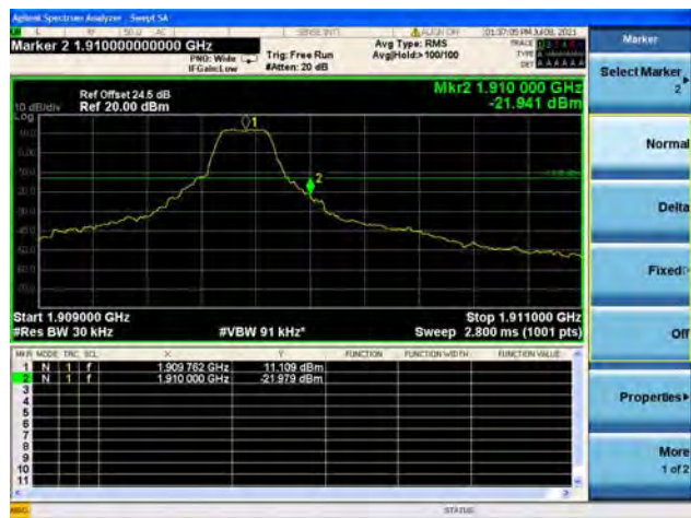
Band2 / 5MHz / Low CH / QPSK / 1 RB
