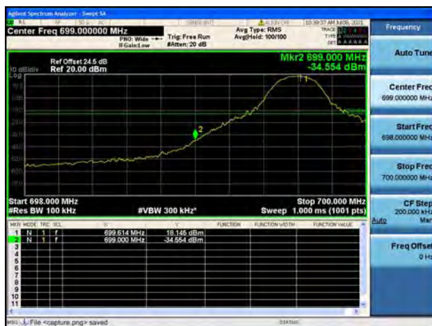
Band12 / 10MHz / Low CH / QPSK / 1 RB
