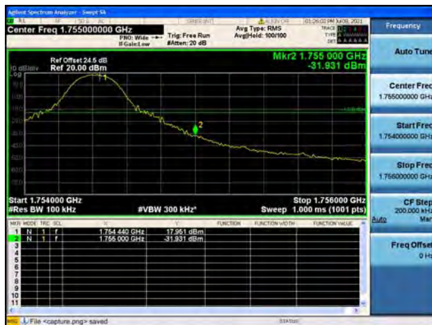
Band4 / 15MHz / Low CH / QPSK / 1 RB
