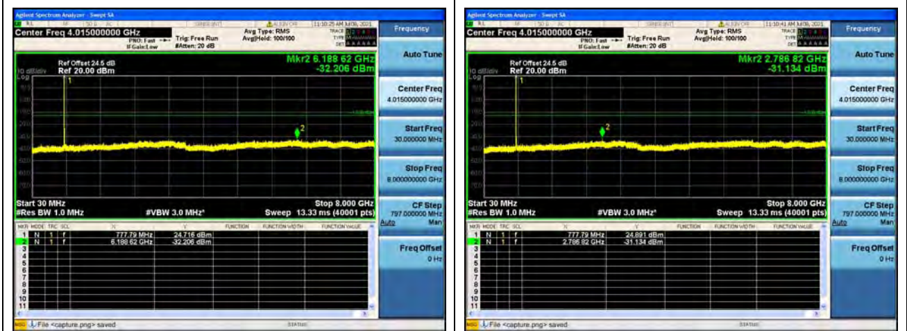
Band13 / 10MHz / Mid CH / 16QAM
