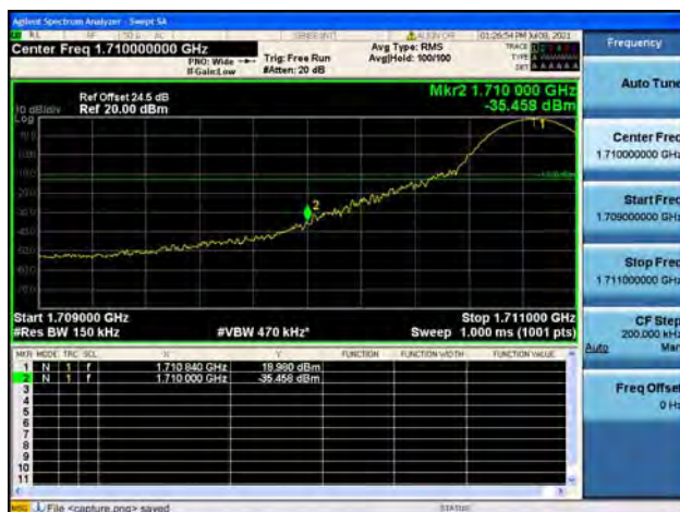
Band4 / 15MHz / Low CH / QPSK / 1 RB
