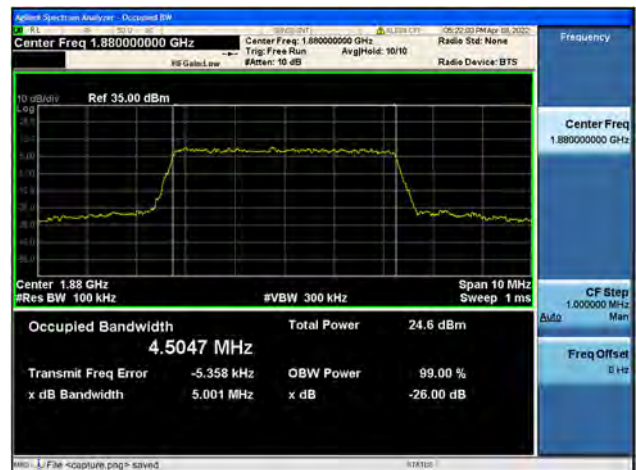
Band2 / 5MHz / Mid CH / 64QAM
