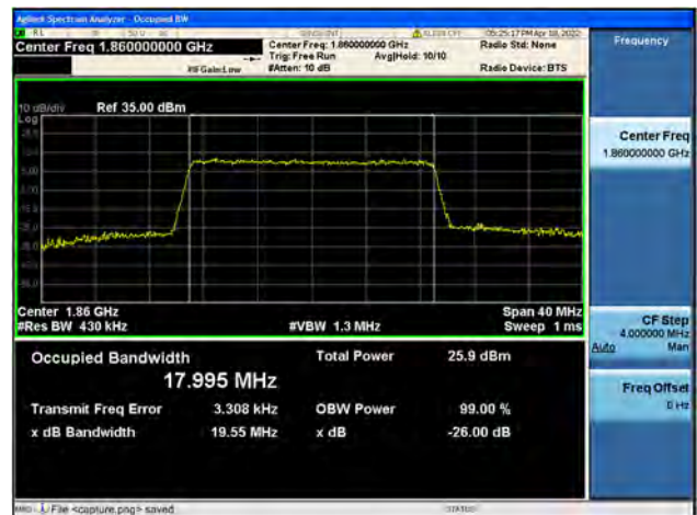
Band2 / 20MHz / Low CH / 64QAM
