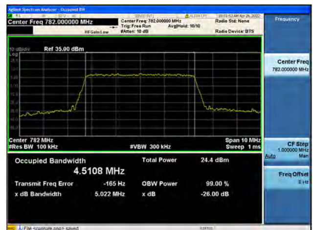
Band13 / 5MHz / Mid CH / 64QAM
