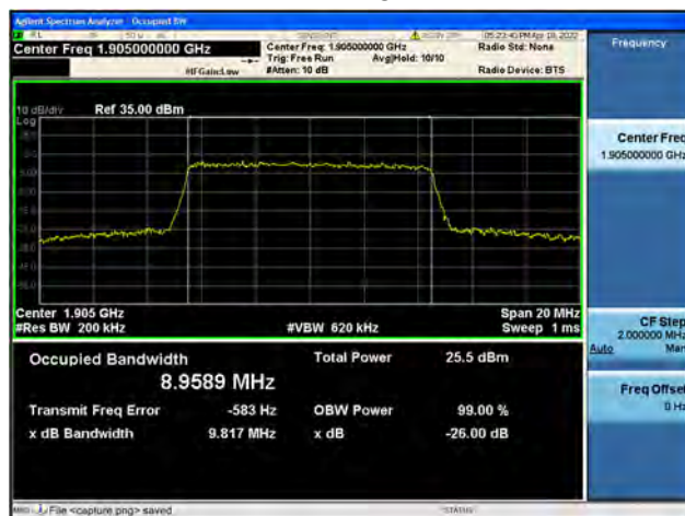
Band2 / 10MHz / High CH / 16QAM
