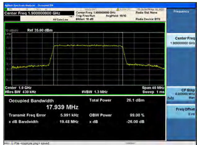
Band2 / 20MHz / High CH / 64QAM
