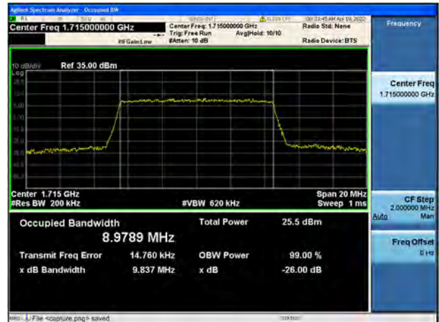
Band4 / 10MHz / Low CH / 64QAM
