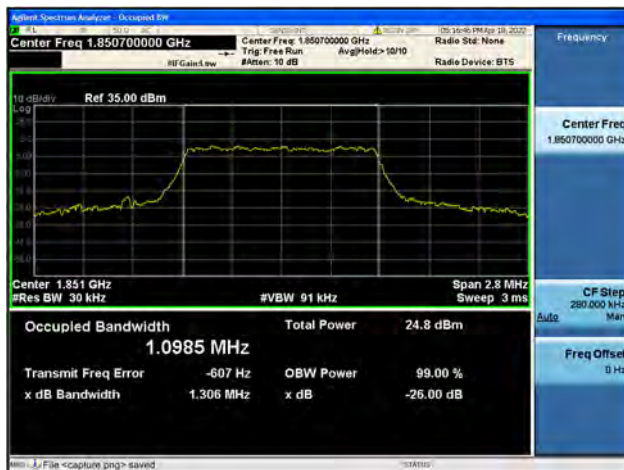
Band2 / 1.4MHz / Mid CH / 16QAM
