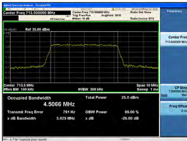
Band12 / 10MHz / Low CH / 16QAM
