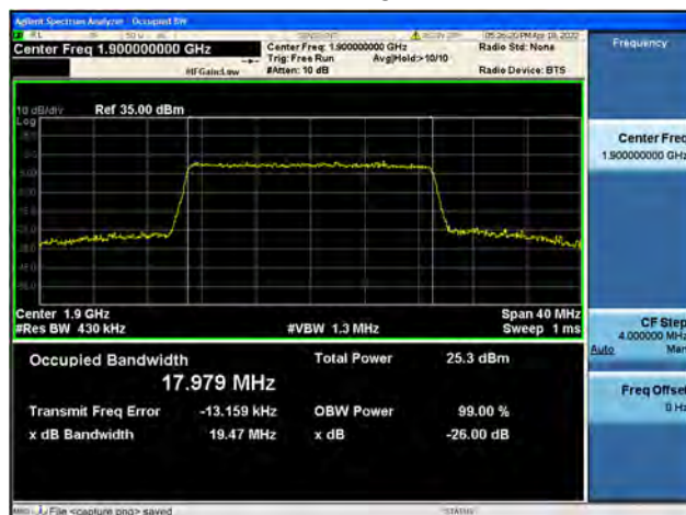
Band2 / 20MHz / High CH / 16QAM
