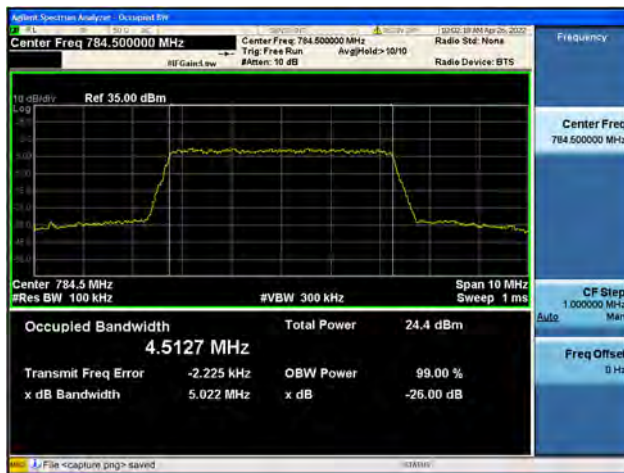
Band13 / 10MHz / Low CH / 16QAM
