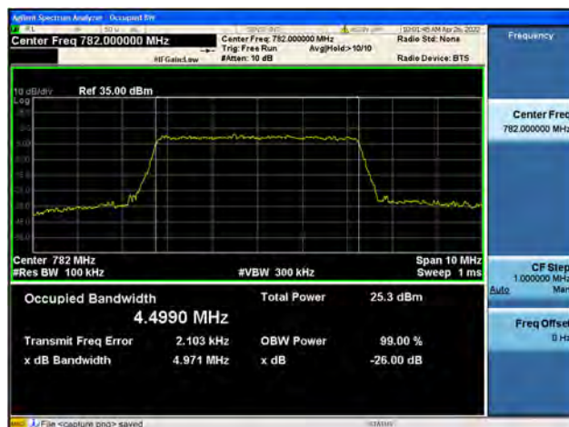
Band13 / 5MHz / Mid CH / 16QAM
