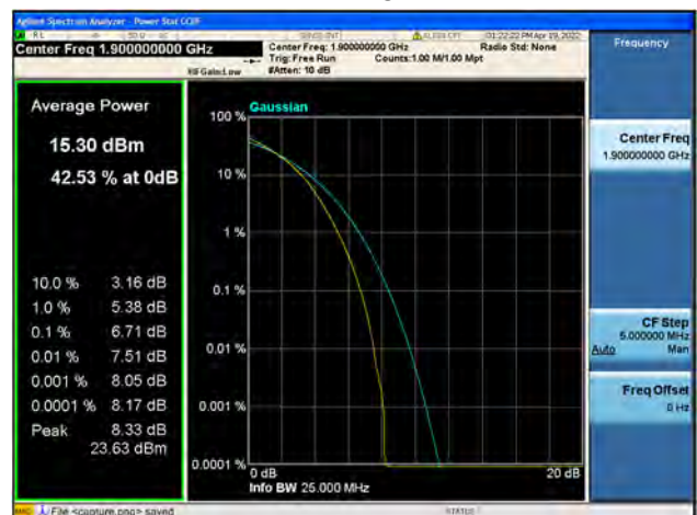
Band2 / 20MHz / High CH / 64QAM
