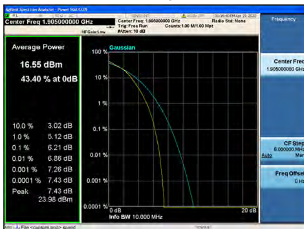
Band2 / 10MHz / High CH / 16QAM
