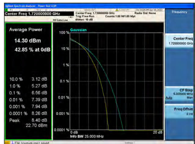
Band4 / 20MHz / Low CH / 64QAM
