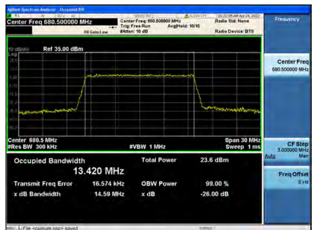
Band71 / 15MHz / Mid CH / 64QAM
