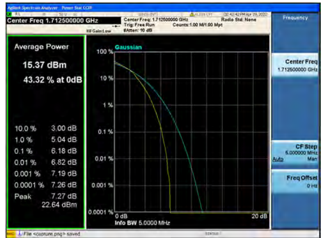
Band66 / 5MHz / Mid CH / QPSK
