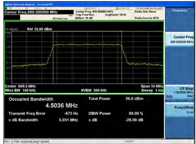
Band71 / 5MHz / Mid CH / 64QAM
