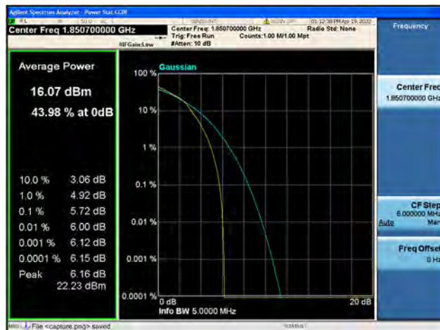
Band2 / 1.4MHz / Mid CH / 16QAM
