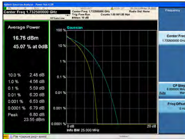
Band4 / 20MHz / Mid CH / 64QAM
