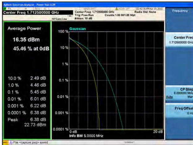
Band66 / 5MHz / Low CH / 64QAM
