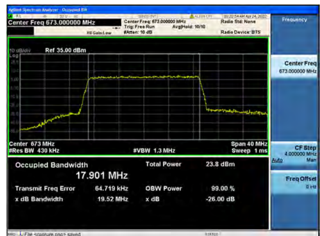
Band71 / 20MHz / Low CH / 64QAM
