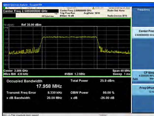
Band41 / 20MHz / Low CH / 16QAM
