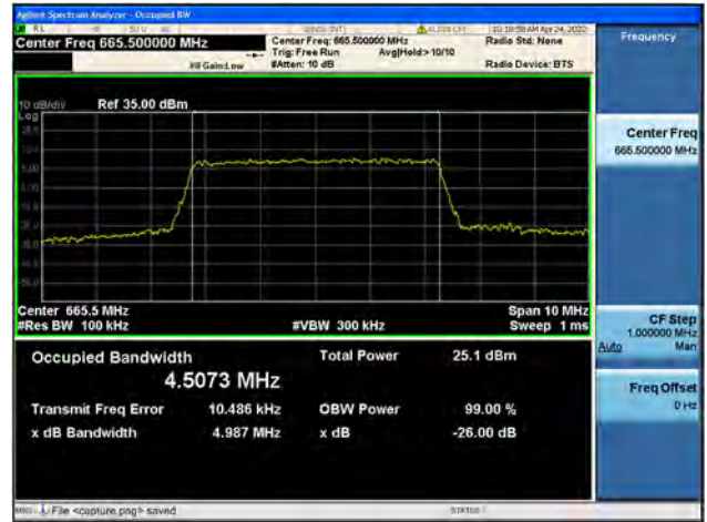
Band71 / 5MHz / Mid CH / QPSK
