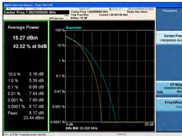
Band2 / 20MHz / Low CH / 16QAM
