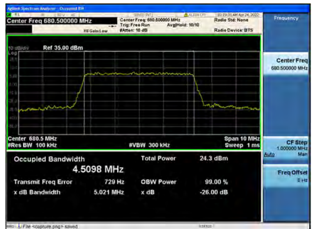
Band71 / 5MHz / Mid CH / 64QAM
