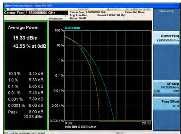
Band2 / 5MHz / Mid CH / 64QAM
