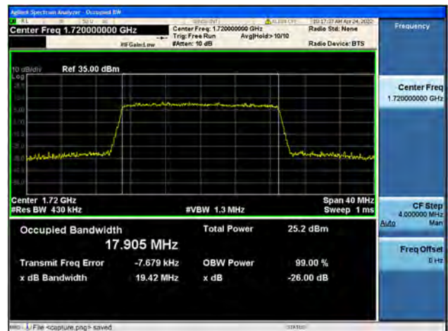
Band66 / 20MHz / Low CH / 64QAM
