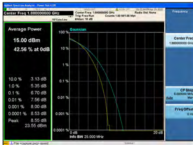
Band2 / 20MHz / High CH / 16QAM
