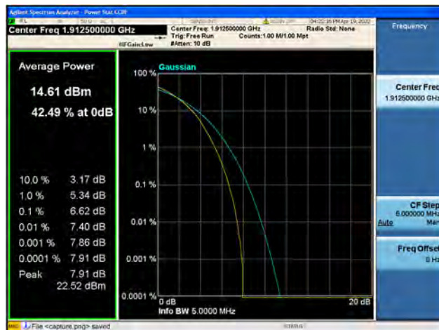
Band25 / 10MHz / Low CH / 16QAM
