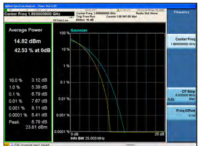
Band2 / 20MHz / Low CH / 64QAM
