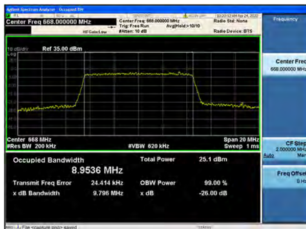
Band71 / 10MHz / Low CH / 16QAM
