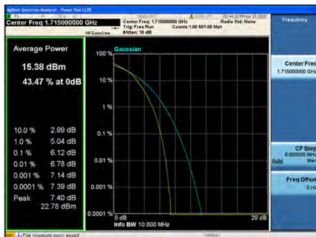
Band66 / 10MHz / Low CH / 16QAM
