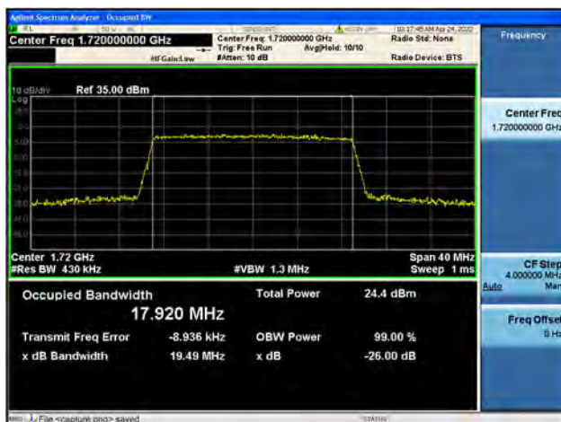
Band66 / 20MHz / Low CH / 16QAM
