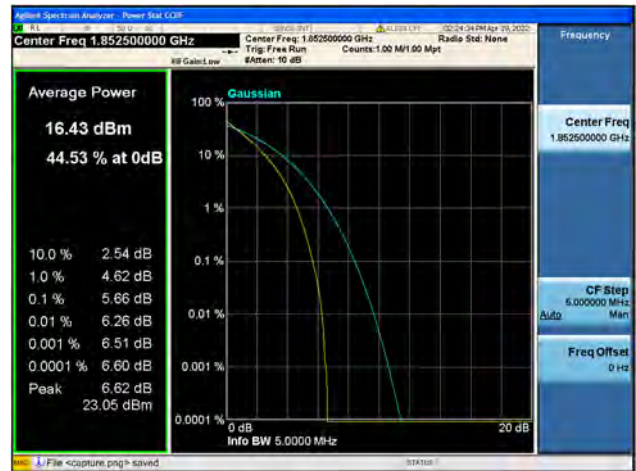
Band25 / 5MHz / Mid CH / QPSK
