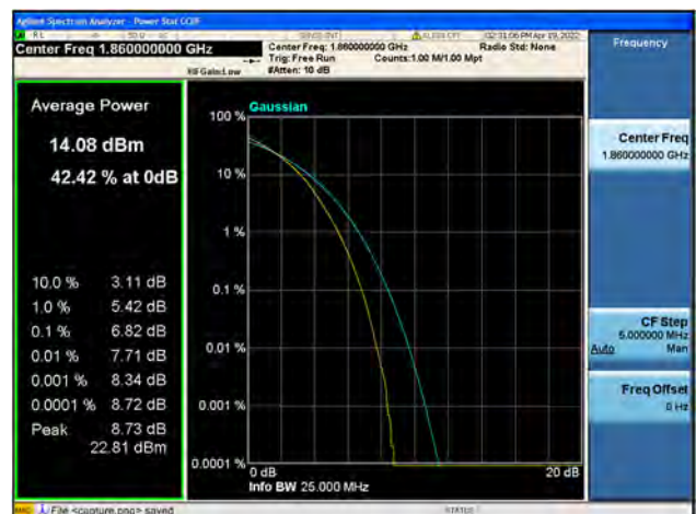
Band25 / 20MHz / Low CH / 64QAM
