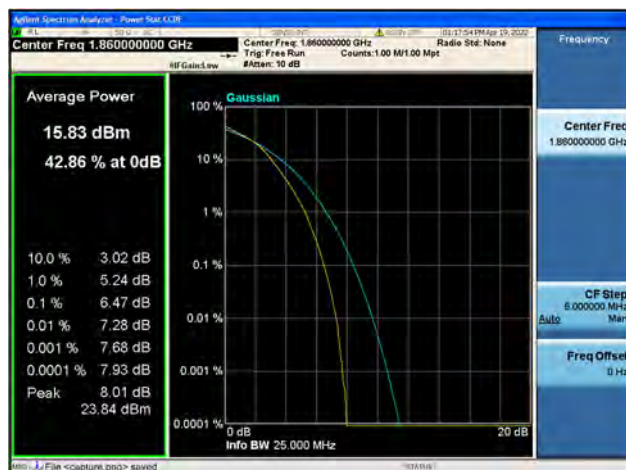
Band2 / 20MHz / Low CH / 16QAM
