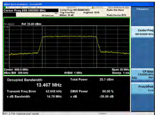
Band71 / 15MHz / Mid CH / 64QAM
