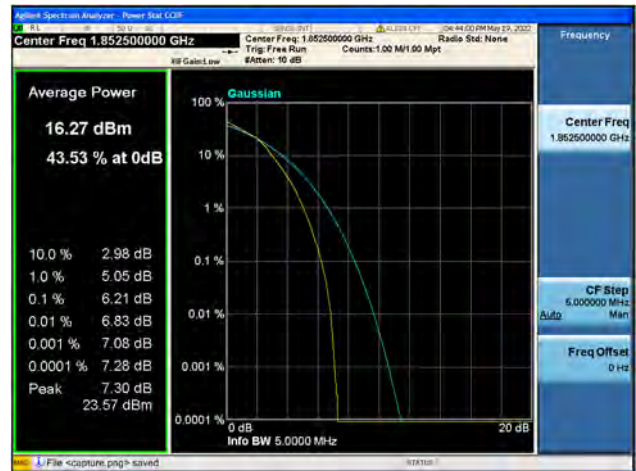
Band25 / 5MHz / Mid CH / QPSK
