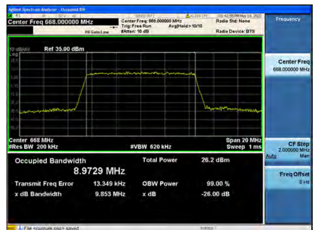
Band71 / 10MHz / Low CH / 64QAM
