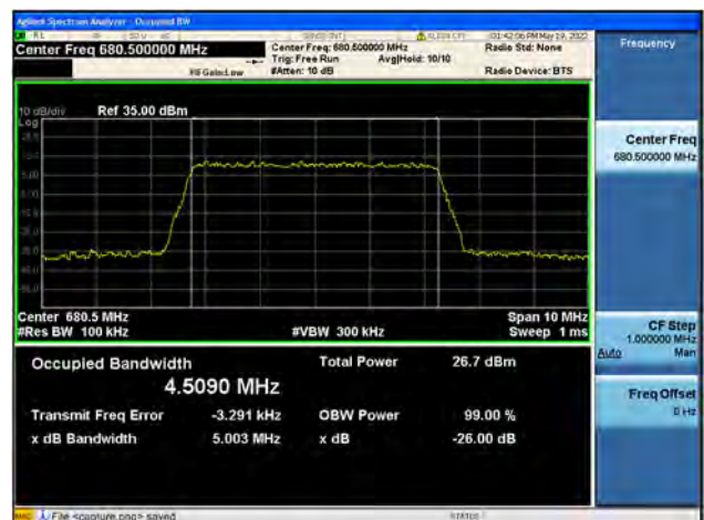
Band71 / 5MHz / Mid CH / 64QAM
