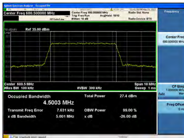
Band71 / 5MHz / Mid CH / 16QAM
