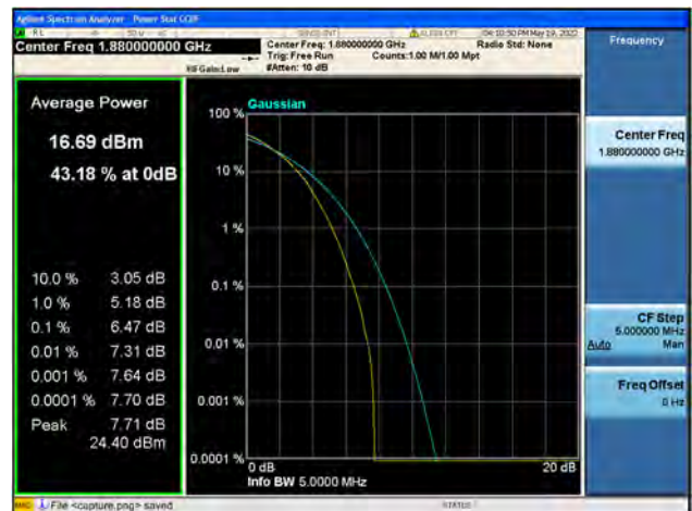
Band2 / 5MHz / Mid CH / 64QAM
