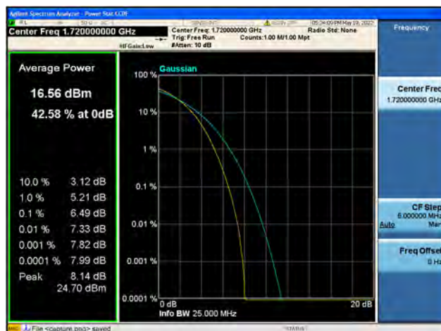
Band66 / 20MHz / Low CH / 64QAM
