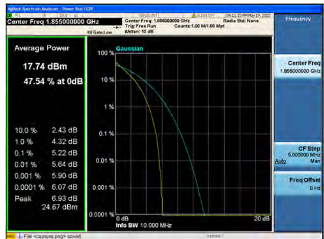
Band2 / 10MHz / Low CH / 64QAM
