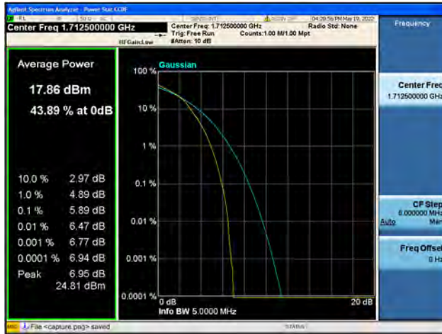
Band4 / 5MHz / Mid CH / QPSK
