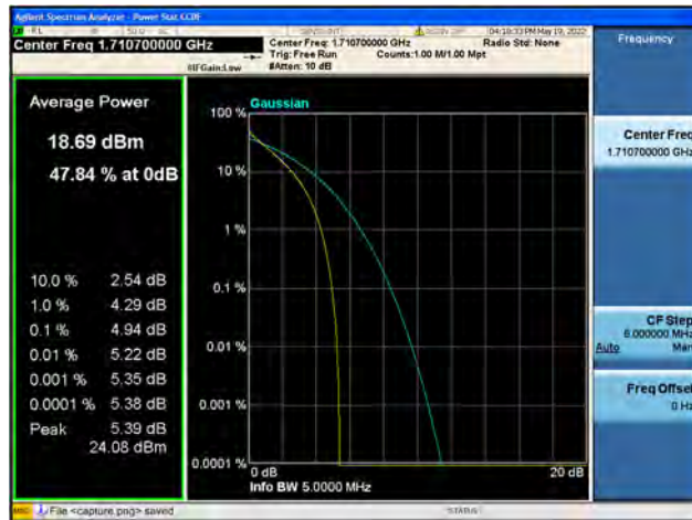
Band4 / 1.4MHz / Low CH / 64QAM
