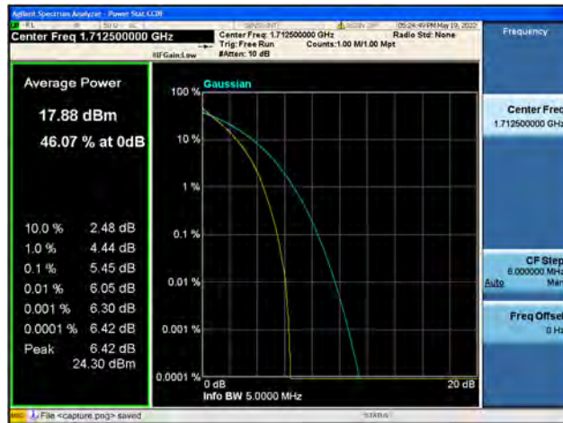
Band66 / 5MHz / Low CH / 64QAM
