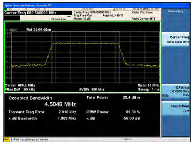
Band71 / 5MHz / Mid CH / 64QAM
