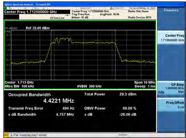
Band66 / 5MHz / Mid CH / QPSK
