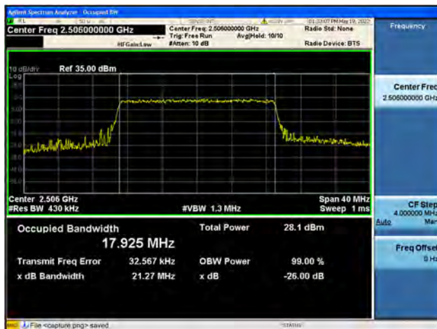
Band41 / 20MHz / Low CH / 16QAM
