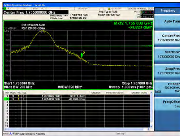
Band4 / 20MHz / High CH / QPSK / 1 RB
