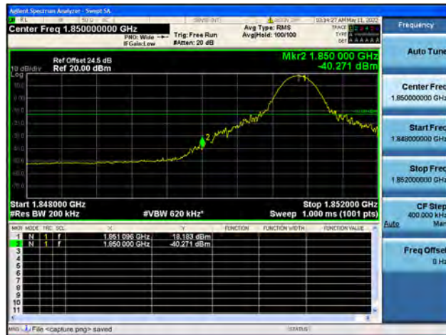
Band2 / 20MHz / High CH / QPSK / 1 RB
