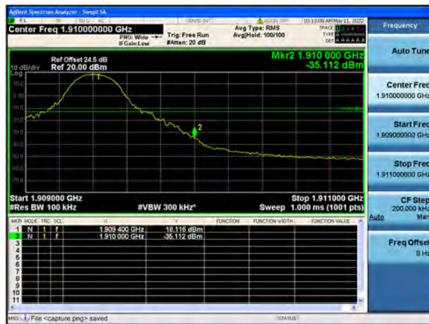
Band2 / 10MHz / High CH / QPSK / 1 RB
