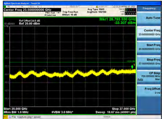
Band41-20G-27G / 20MHz / Low CH / 16QAM
