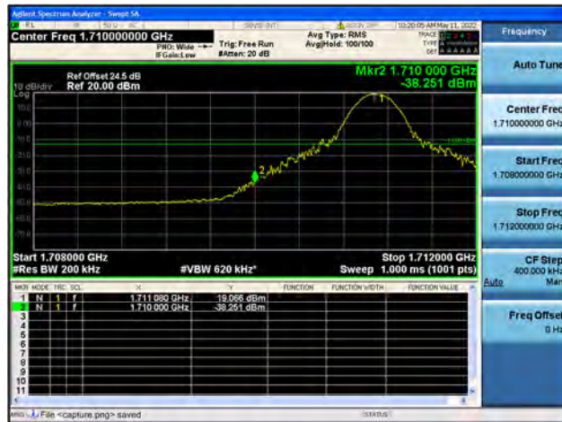
Band4 / 20MHz / High CH / QPSK / 1 RB
