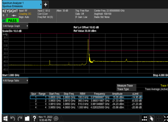
N77(50M)_CP- OFDM_QPSK Edge 1RB Right High CH
