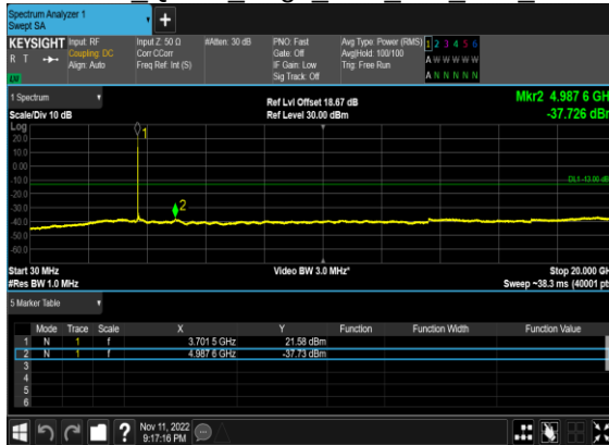
N77(50M)_CP- OFDM QPSK Edge 1RB Left Low CH
