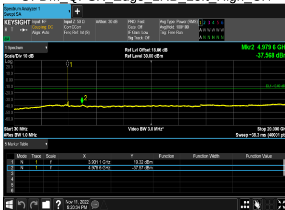
N77(50M)_CP- OFDM QPSK Edge 1RB Left High CH
