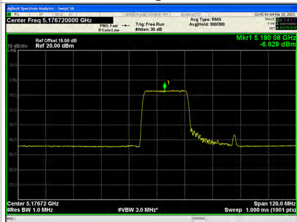
PSD NVNT ax80 242@61 5210MHz Ant3
