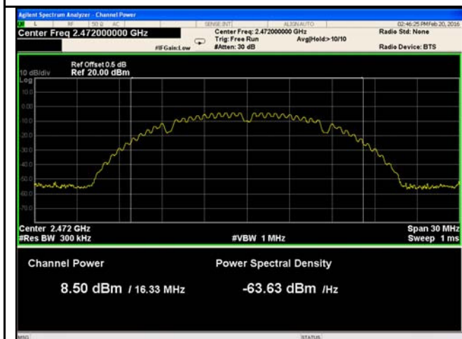
802.11b - AV Output power - High CH 2472
