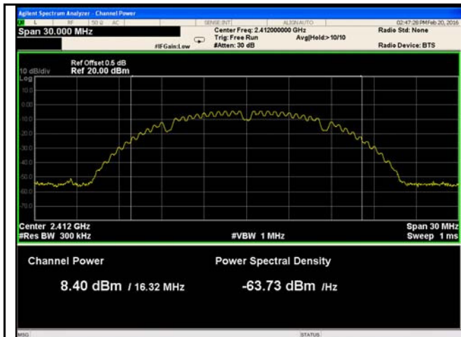
802.11b - AV Output power - Low CH 2412
