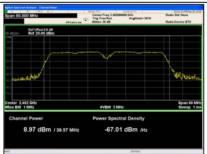
802.11n40 - AV Output power - High CH 2462
