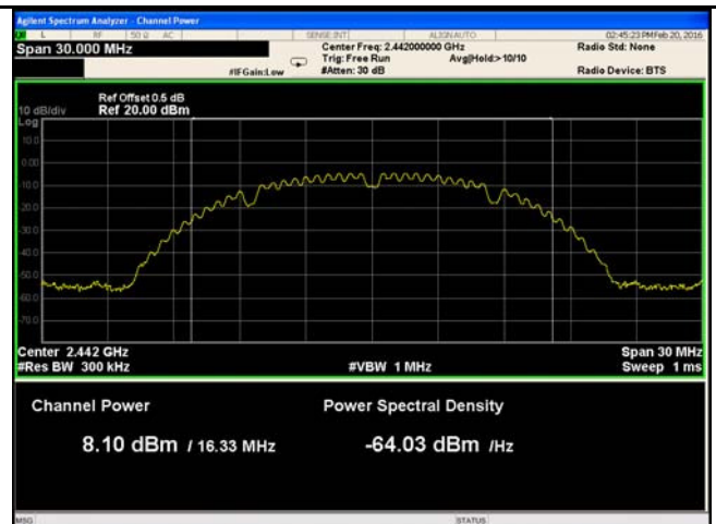
802.11b - AV Output power - Mid CH 2442
