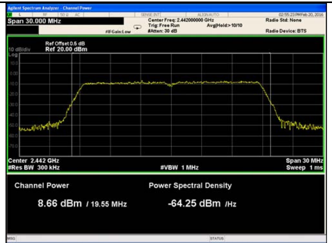
802.11n20 - AV Output power - Mid CH 2442
