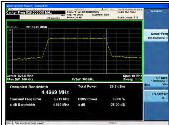
Band5 / 5MHz / QPSK/ Low CH
