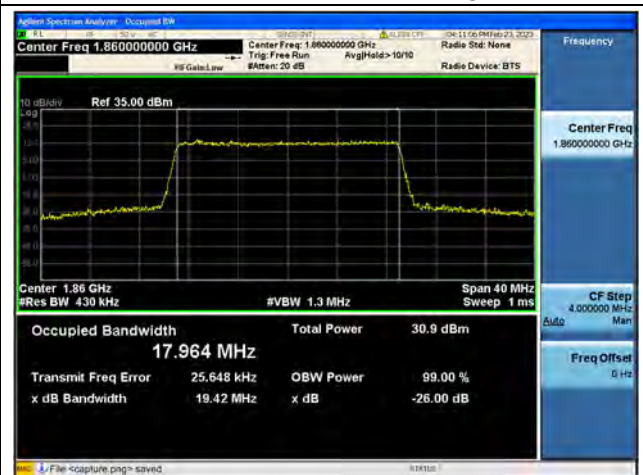
Band2 / 20MHz / QPSK/ Low CH
