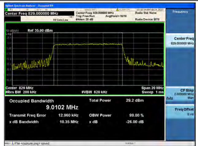
Band5 / 10MHz / QPSK/ Low CH
