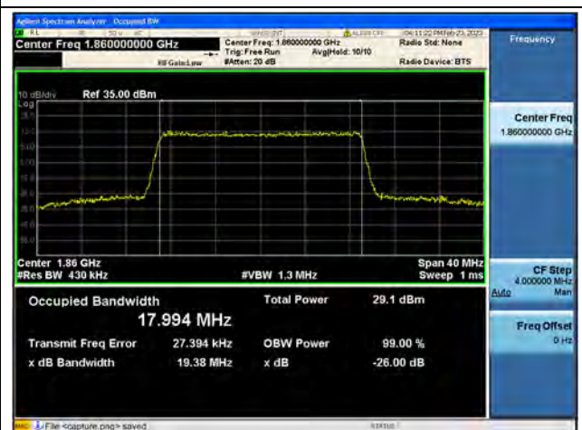
Band2 / 20MHz / 64QAM/ Low CH
