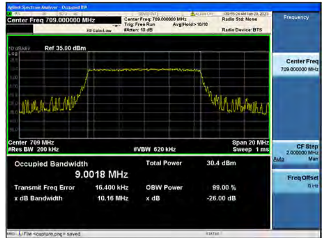
Band17 / 10MHz / QPSK/ Low CH
