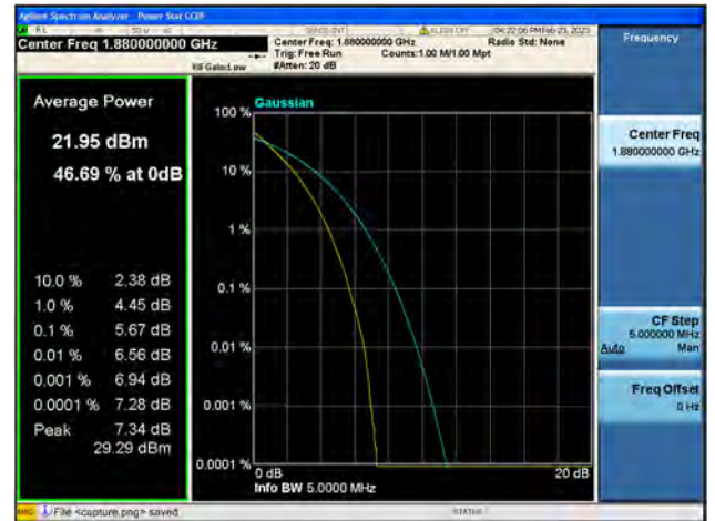
Band2 / 5MHz / Mid CH / QPSK
