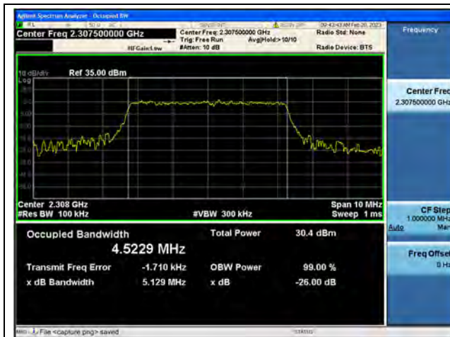
Band40-1 / 5MHz / QPSK/ Low CH
