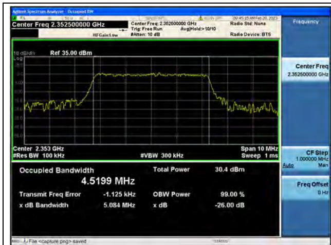
Band40-2 / 5MHz / QPSK/ Low CH
