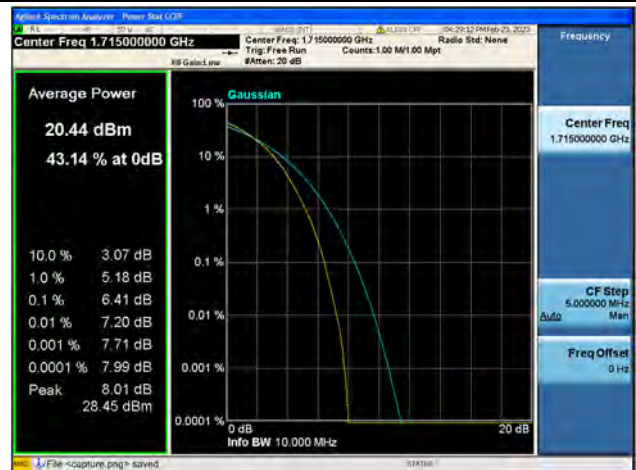
Band4 / 10MHz / Low CH / 64QAM
