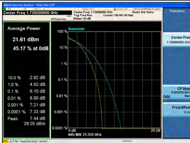
Band4 / 20MHz / Low CH / 16QAM
