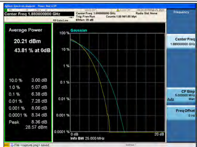
Band2 / 15MHz / Mid CH / 64QAM
