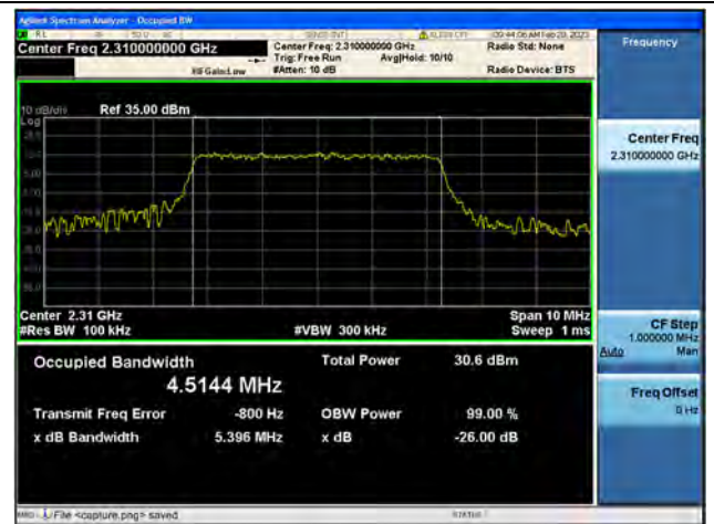
Band40-1 / 5MHz / QPSK/ Mid CH
