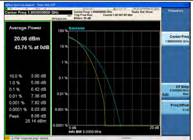
Band2 / 5MHz / Mid CH / 64QAM
