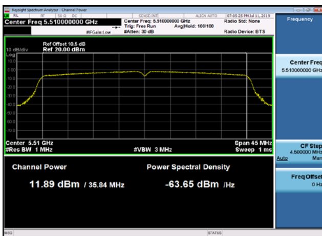
U-NII-2c Output Power-802.11ac(40MHz) ,5510MHz
