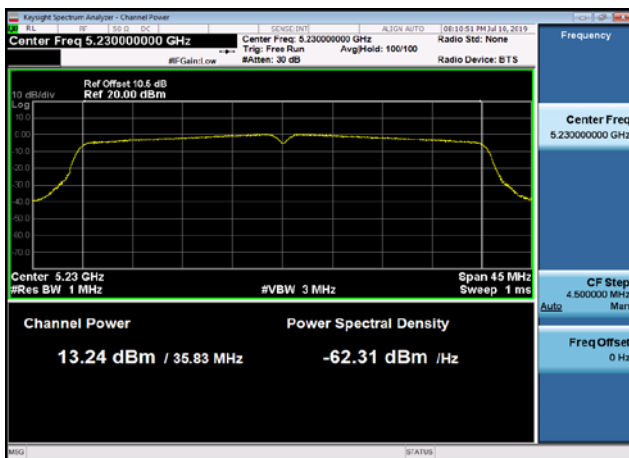
U-NII-1 Output Power-802.11n(40MHz) ,5230MHz
