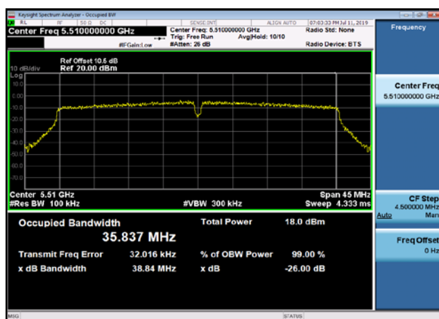
U-NII-2c 26dB Bandwidth-802.11ac(40MHz),5510MHz
