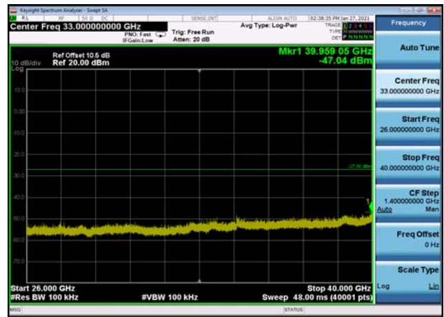
U-NII-2a ,Plot 1,Band Edge-802.11n(40 MHz),5310MHz,Ant1
