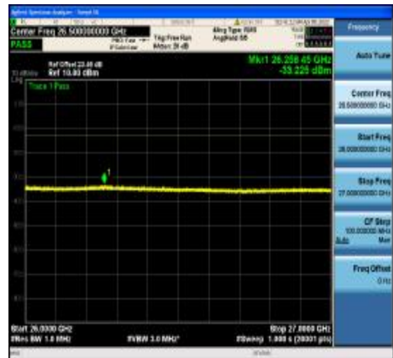
1-N77-3700-3980-PC2-30-60-M-19-CP-16Q AM-Edge_1RB_Left-1@0-26000-40000-Ant1 --33.22--13-PASS
