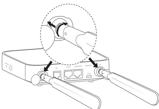
③ Enrosque las antenas externas por completo en el puerto de antena.
