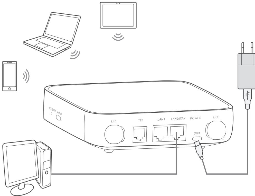
Para evitar las interferencias provocadas de las señales de radio, coloque el router Cat4 al menos a un metro de dispositivos y otros dispositivos eléctricos.
