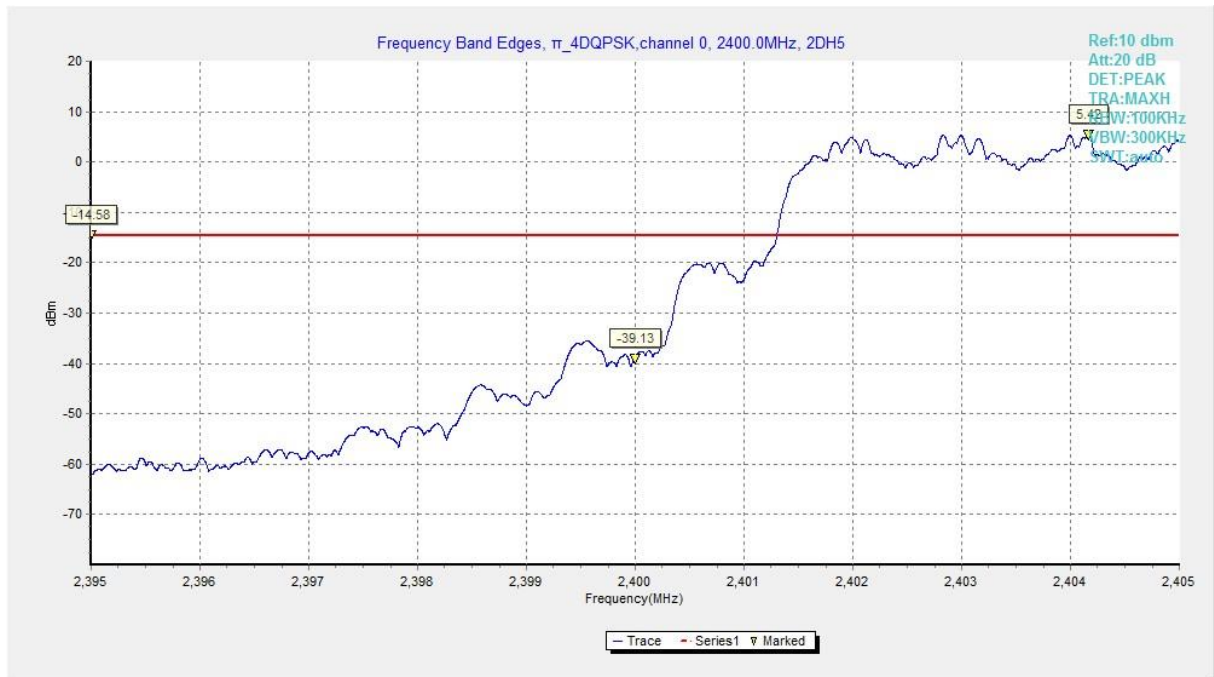
Fig. 3 Band Edges ( \pi /4 DQPSK, Ch 0, Hopping ON)
