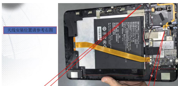
金属后壳镭雕处需要用导电海绵做接地处理。
