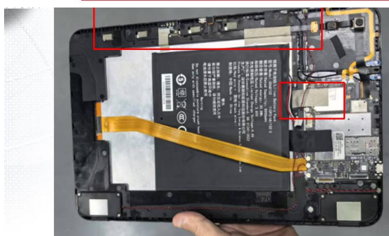
需要用导电海绵对金属后壳镭雕处做接地处理，主板端需要用导电布做接地处理。
