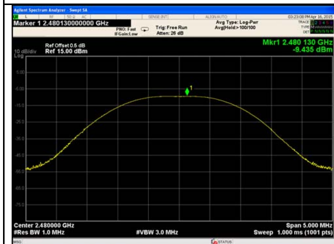
AV Output power - High CH 2480
