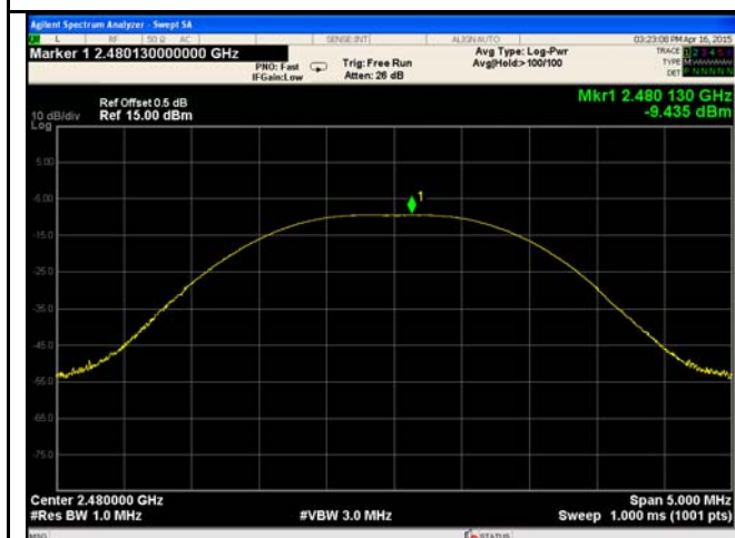
AV Output power - High CH 2480
