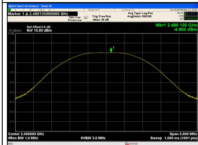
AV Output power - High CH 2480
