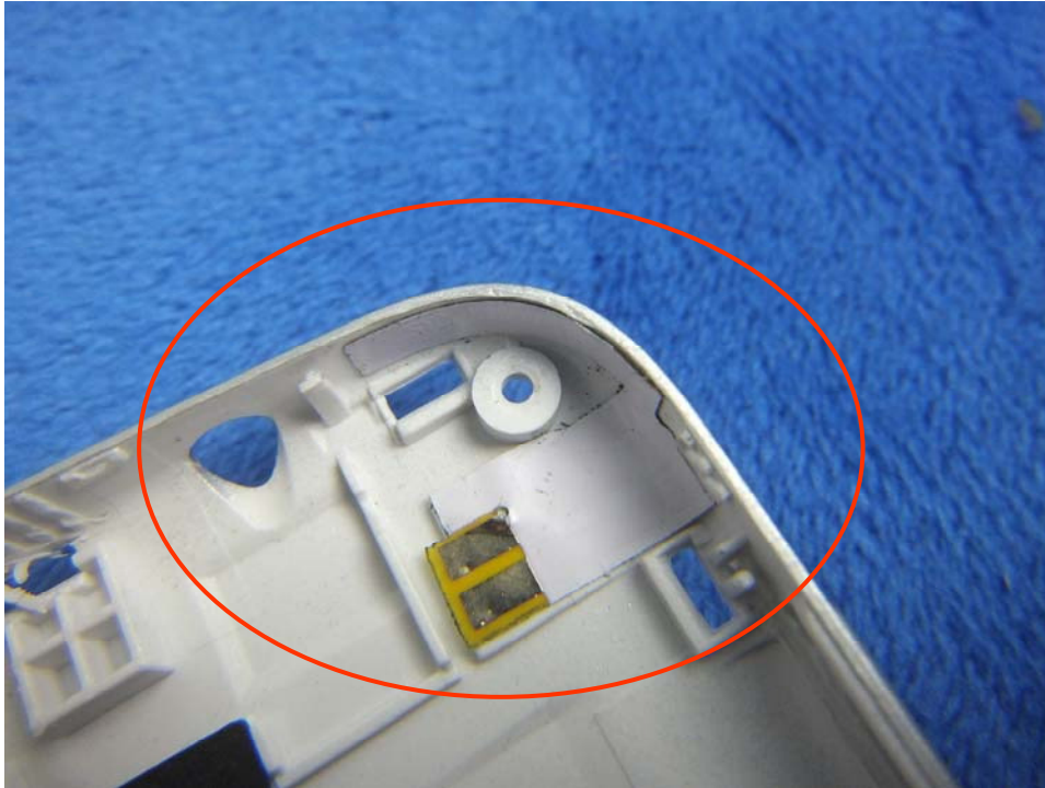
BT/WIFI/GPS - Antenna View
