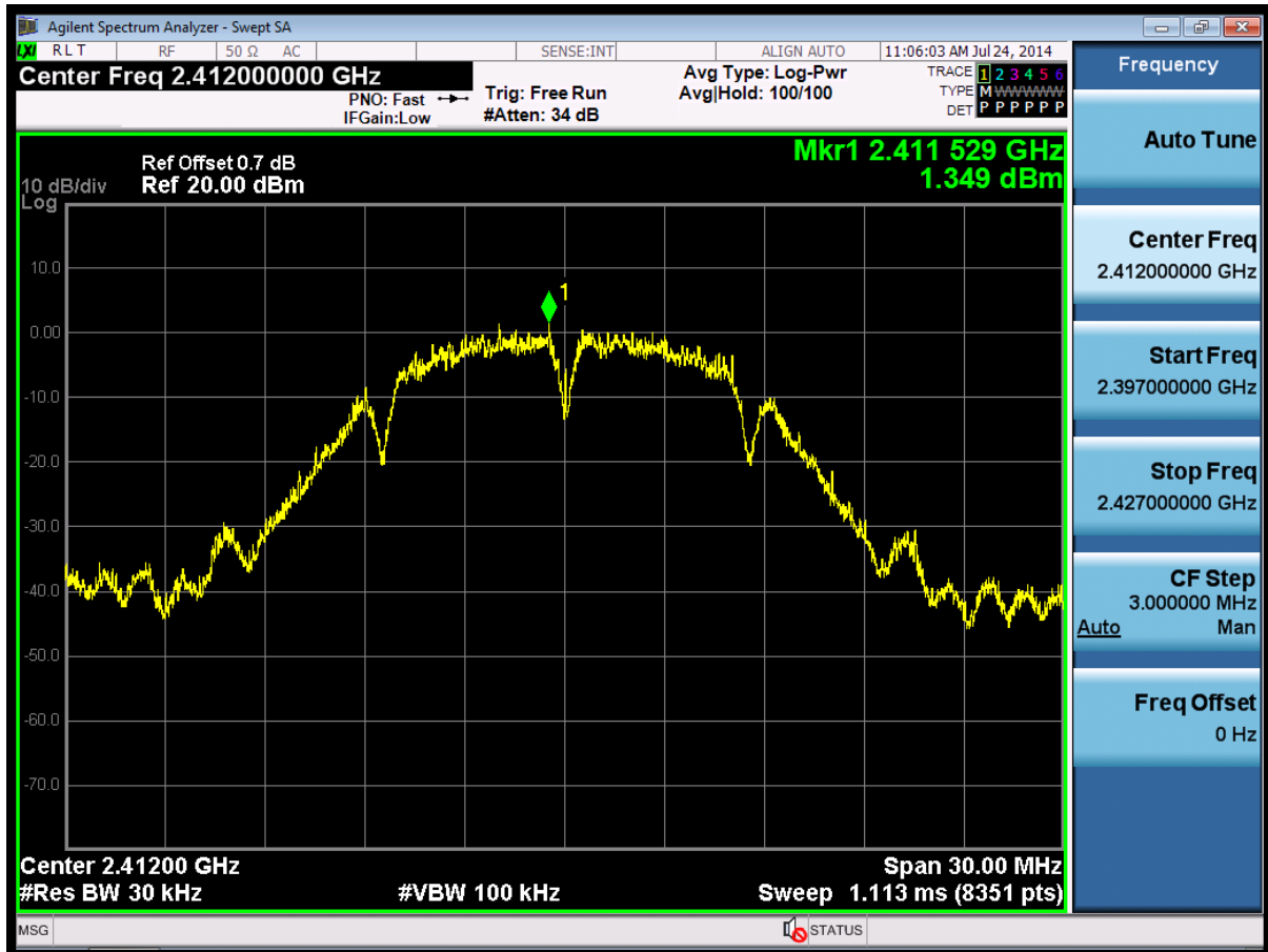
(Plot 4.4.1 A: Channel 1: 2412MHz @ 802.11b)
