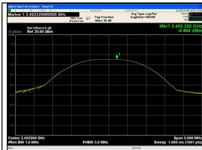
AV Output power - Low CH 2402
