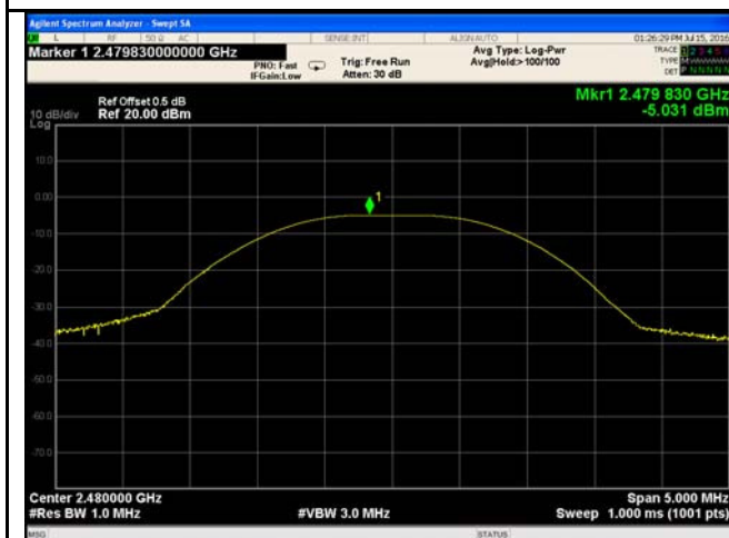
AV Output power - High CH 2480
