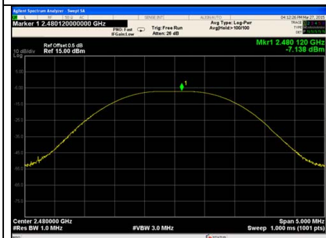
AV Output power - High CH 2480
