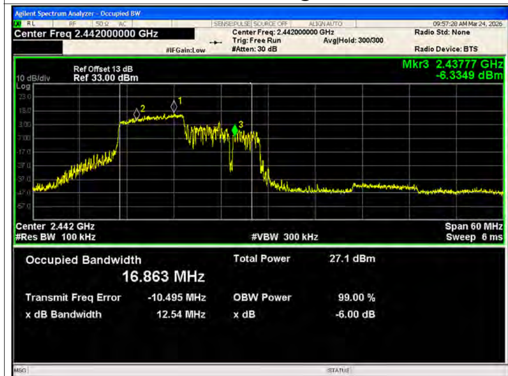
-6dB Bandwidth NVNT ax40 106@53 2442MHz Ant1
