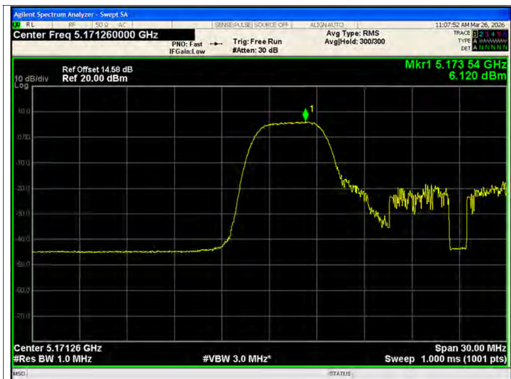
PSD NVNT ax20 52@1 5180MHz Ant1 MIMO
