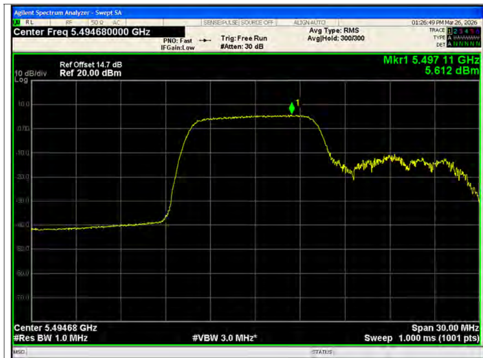
PSD NVNT ax20 106@1 5500MHz Ant1 MIMO
