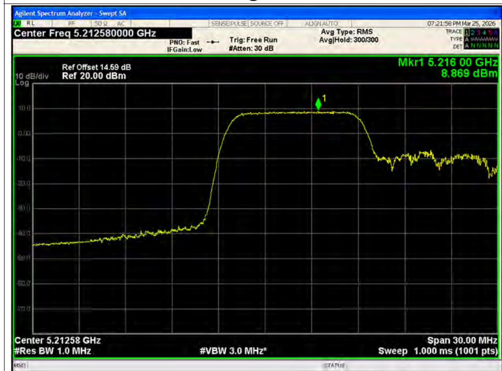
PSD NVNT ax20 106@1 5220MHz Ant1 SISO
