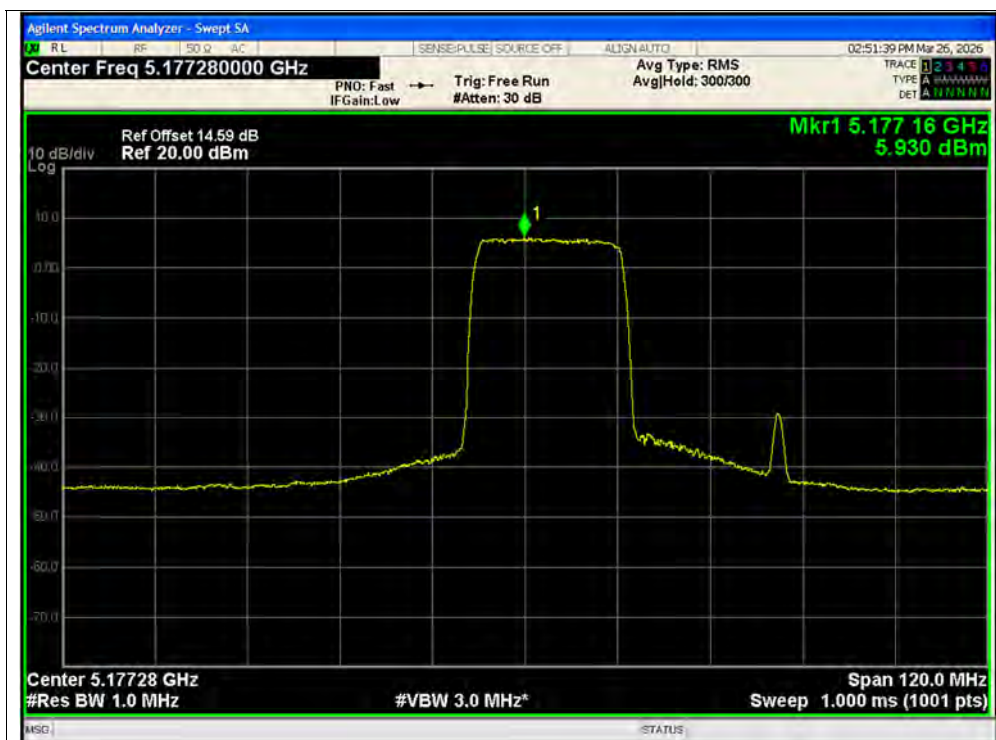
PSD NVNT ax80 242@1 5210MHz Ant1 SISO
