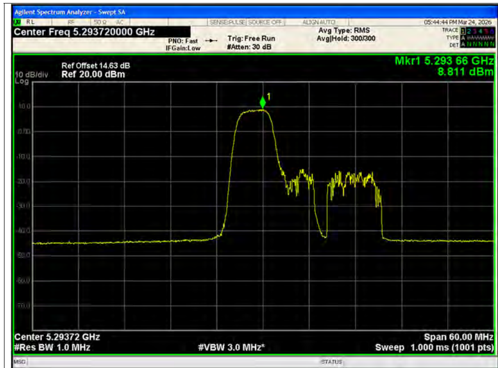
PSD NVNT ax20 52@1 5300MHz Ant1 SISO
