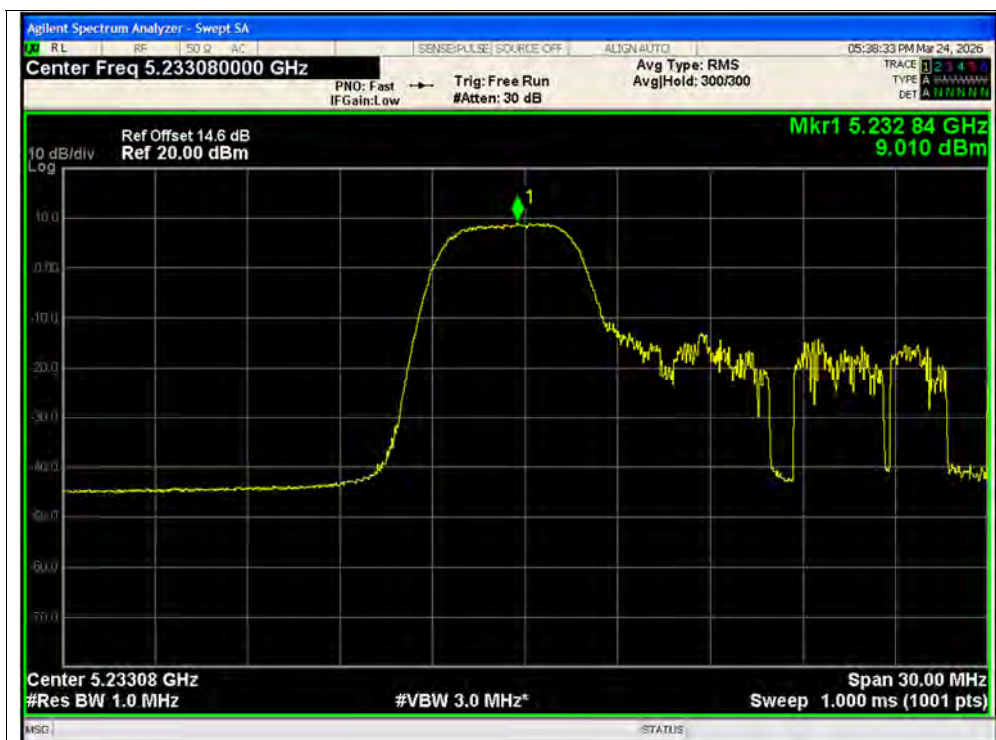
PSD NVNT ax20 52@1 5240MHz Ant1 SISO
