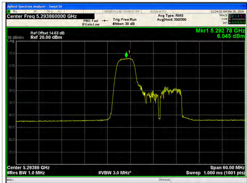
PSD NVNT ax20 52@1 5300MHz Ant1 MIMO
