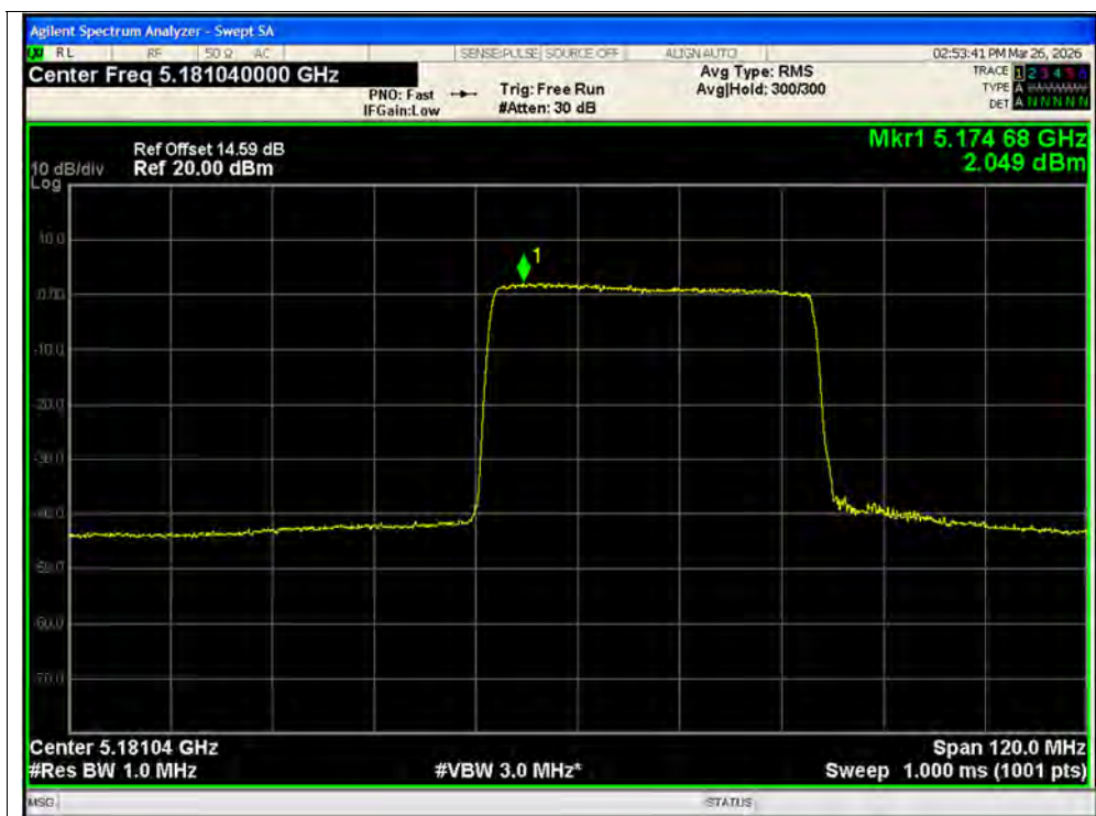
PSD NVNT ax80 484@1 5210MHz Ant1 SISO
