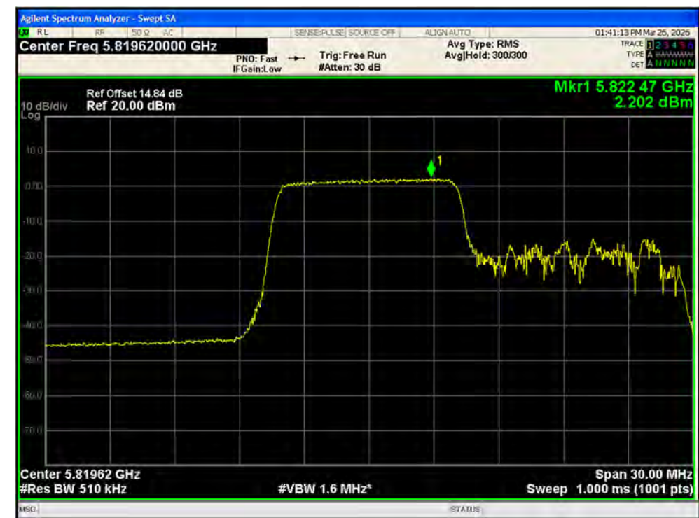
PSD NVNT ax20 106@1 5825MHz Ant1 MIMO
