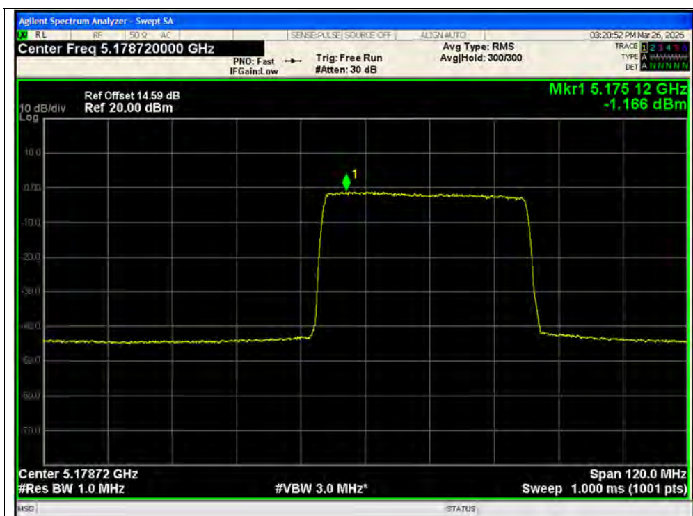
PSD NVNT ax80 484@1 5210MHz Ant1 MIMO
