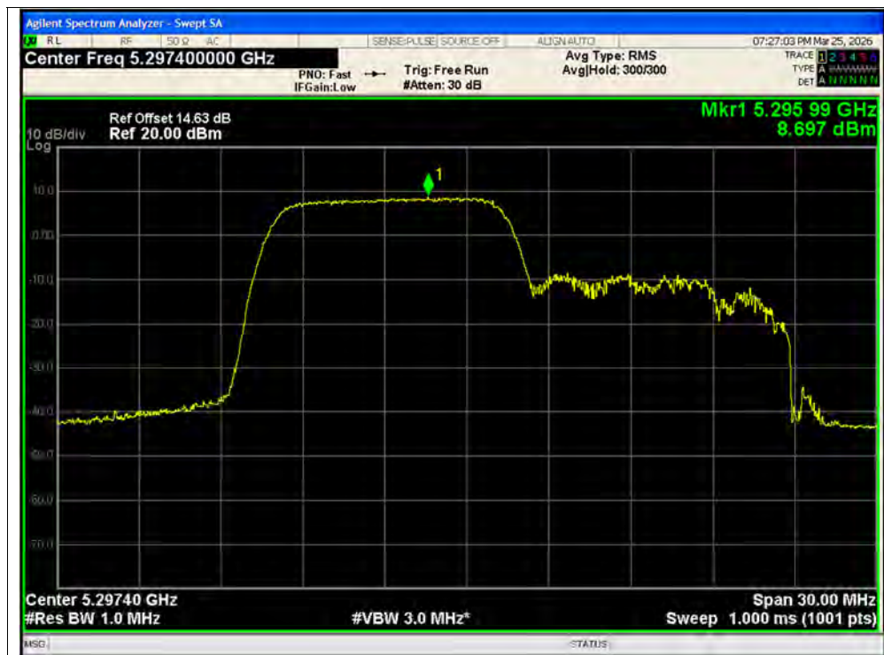
PSD NVNT ax20 106@1 5300MHz Ant1 SISO
