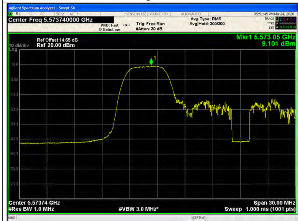
PSD NVNT ax20 52@1 5580MHz Ant1 SISO
