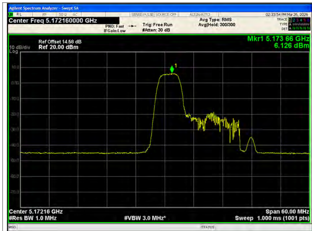
PSD NVNT ax40 52@1 5190MHz Ant1 MIMO
