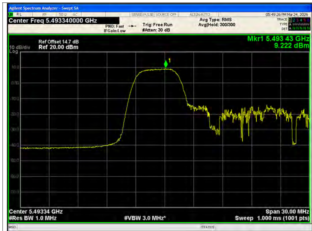
PSD NVNT ax20 52@1 5500MHz Ant1 SISO
