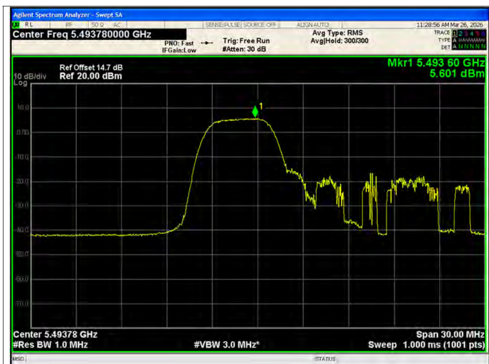
PSD NVNT ax20 52@1 5500MHz Ant1 MIMO
