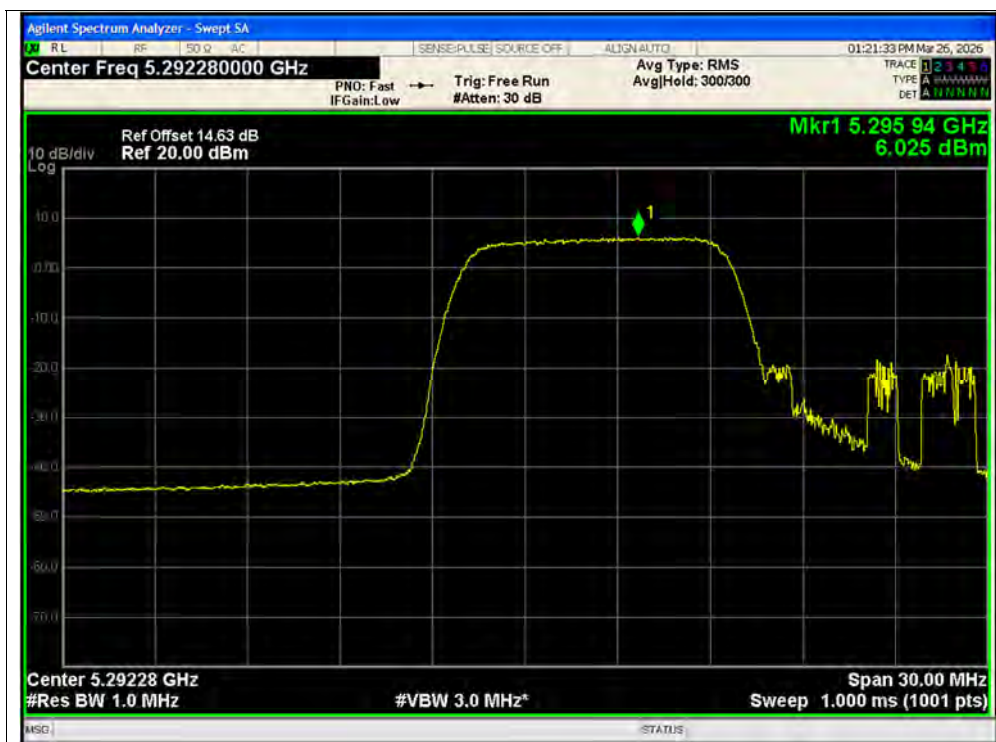
PSD NVNT ax20 106@1 5300MHz Ant1 MIMO
