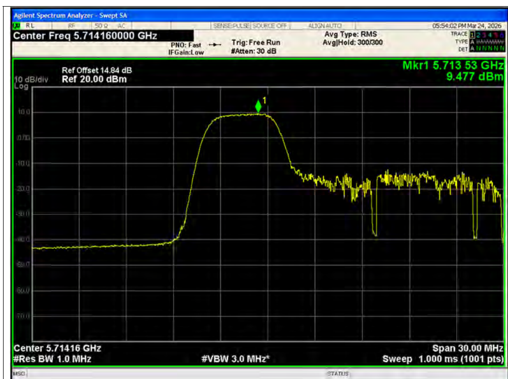
PSD NVNT ax20 52@1 5720MHz Ant1 SISO
