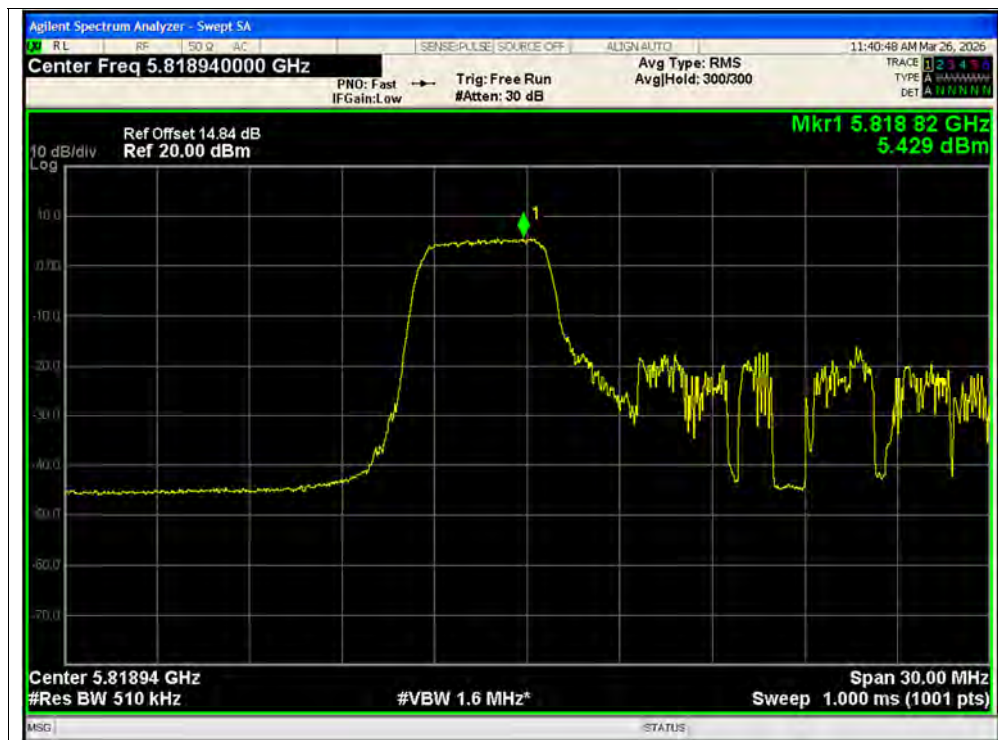
PSD NVNT ax20 52@1 5825MHz Ant1 MIMO
