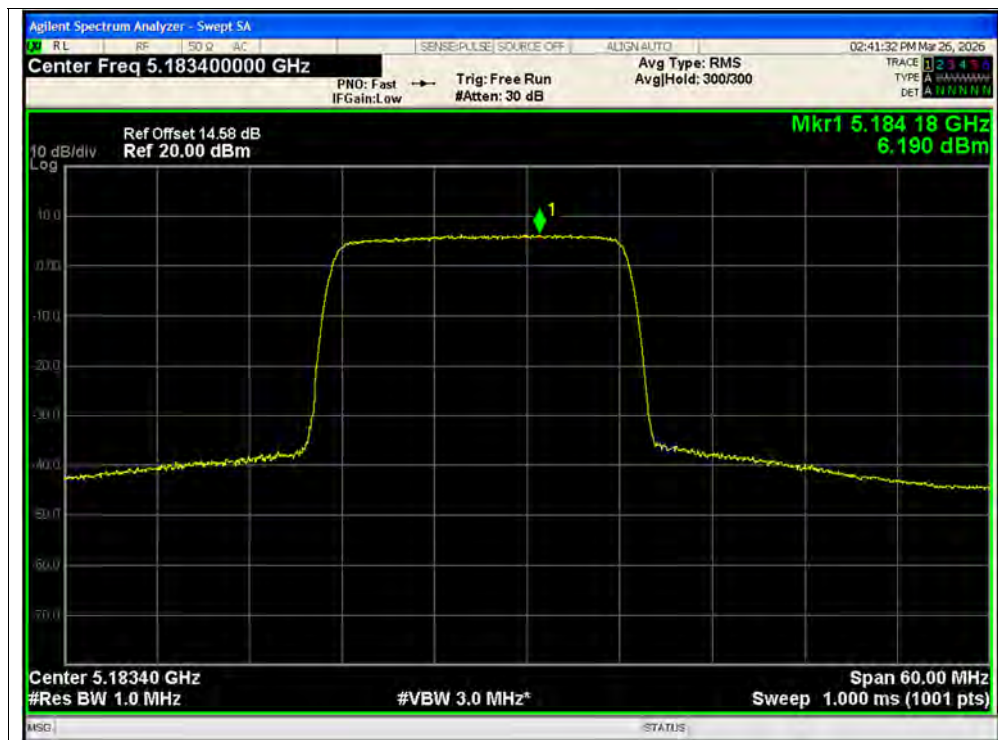
PSD NVNT ax40 242@1 5190MHz Ant1 MIMO
