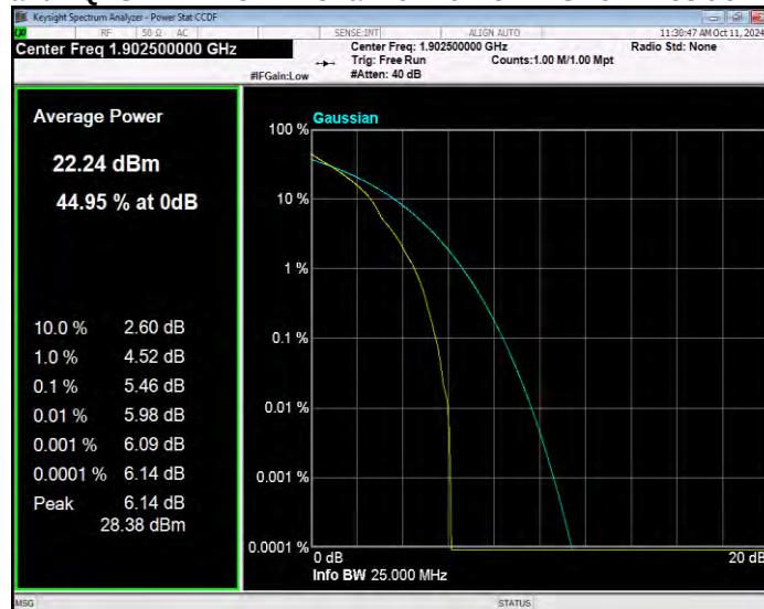
Band2 QPSK BW=20MHz Channel=18700 RB Size=1 Position=#0
