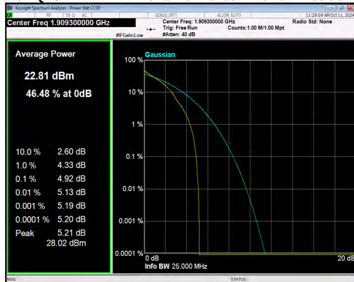
Band2 QPSK BW=10MHz Channel=18650 RB Size=1 Position=#0
