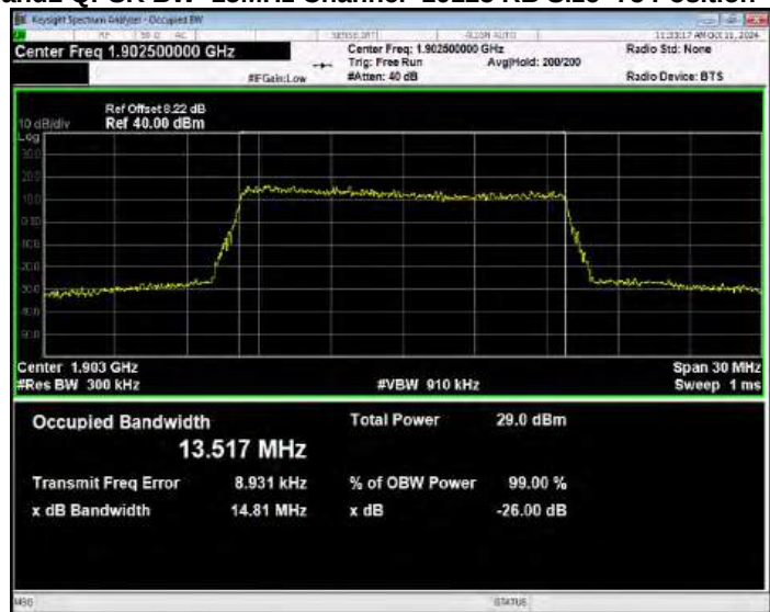
Band2 QPSK BW=20MHz Channel=18700 RB Size=100 Position=#0
