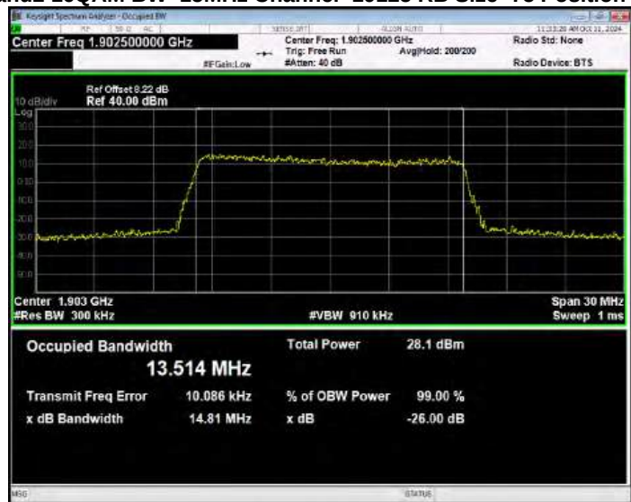
Band2 16QAM BW=20MHz Channel=18700 RB Size=100 Position=#0
