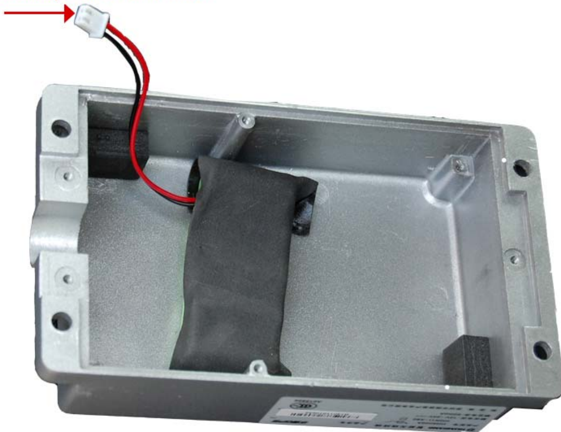
【Backup battery installation diagram】
