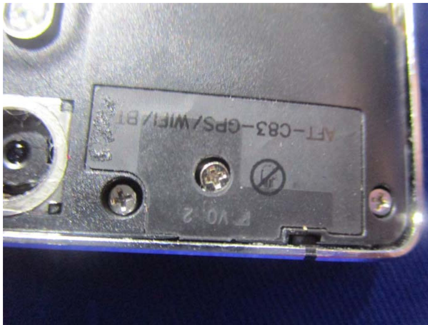
EUT –BT&WIFI&GPS Antenna View
