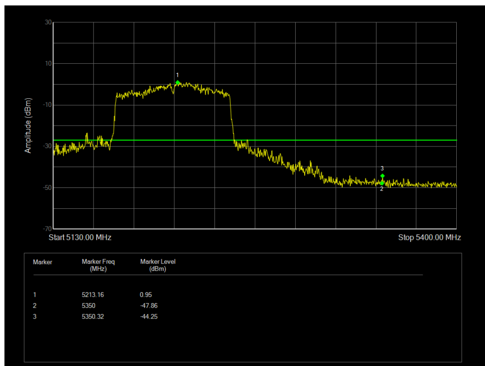
Band Edge NVNT 802.11ac80 5210MHz Low Ant1
