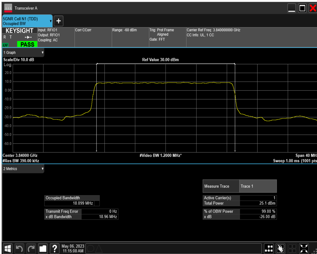
n77(3700-3980) SCS=30kHz DFT_QPSK BW=20MHz Channel=656000 RB=50@0
