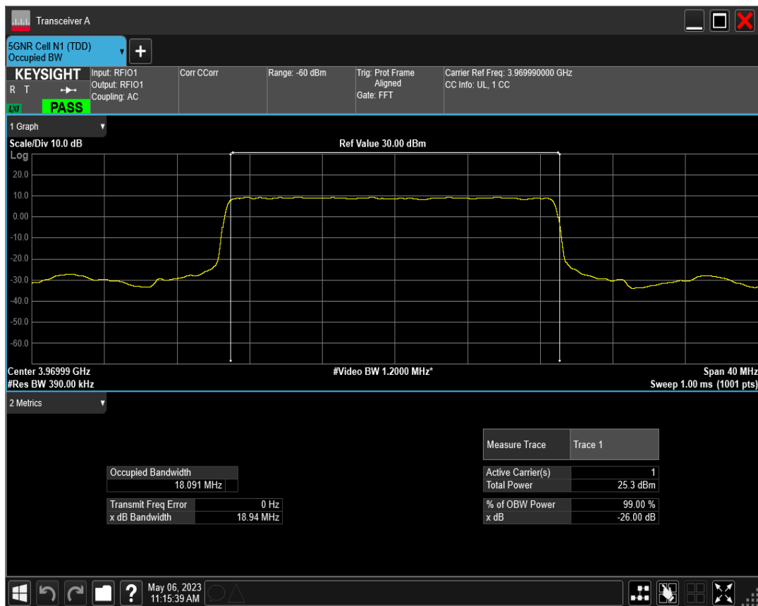
n77(3700-3980) SCS=30kHz DFT_QPSK BW=20MHz Channel=664666 RB=50@0
