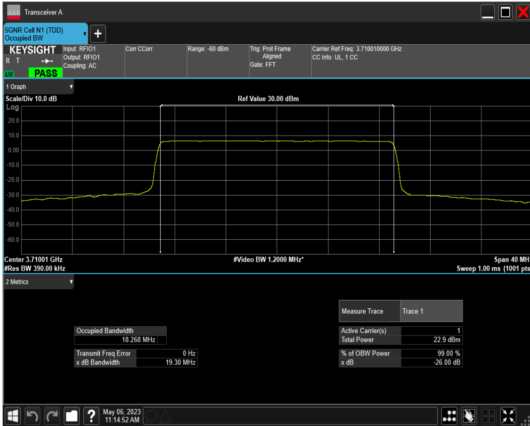
n77(3700-3980) SCS=30kHz DFT_BPSK BW=20MHz Channel=656000 RB=50@0
