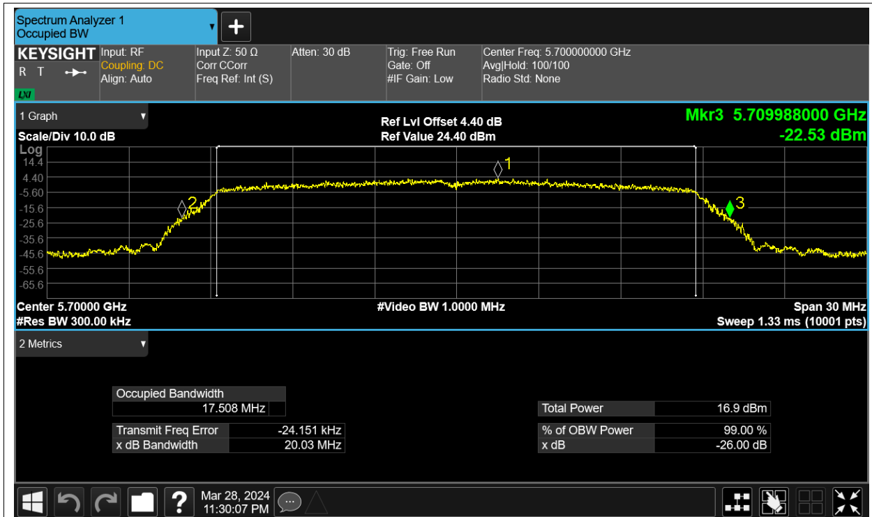
-26dB Bandwidth NVNT ac20 5700MHz Ant4
