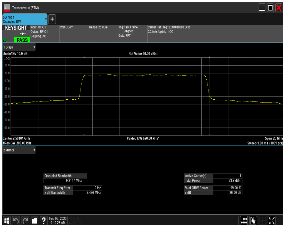
n41 SCS=15kHz DFT_QAM256 BW=10MHz Channel=500202 RB=50@0
