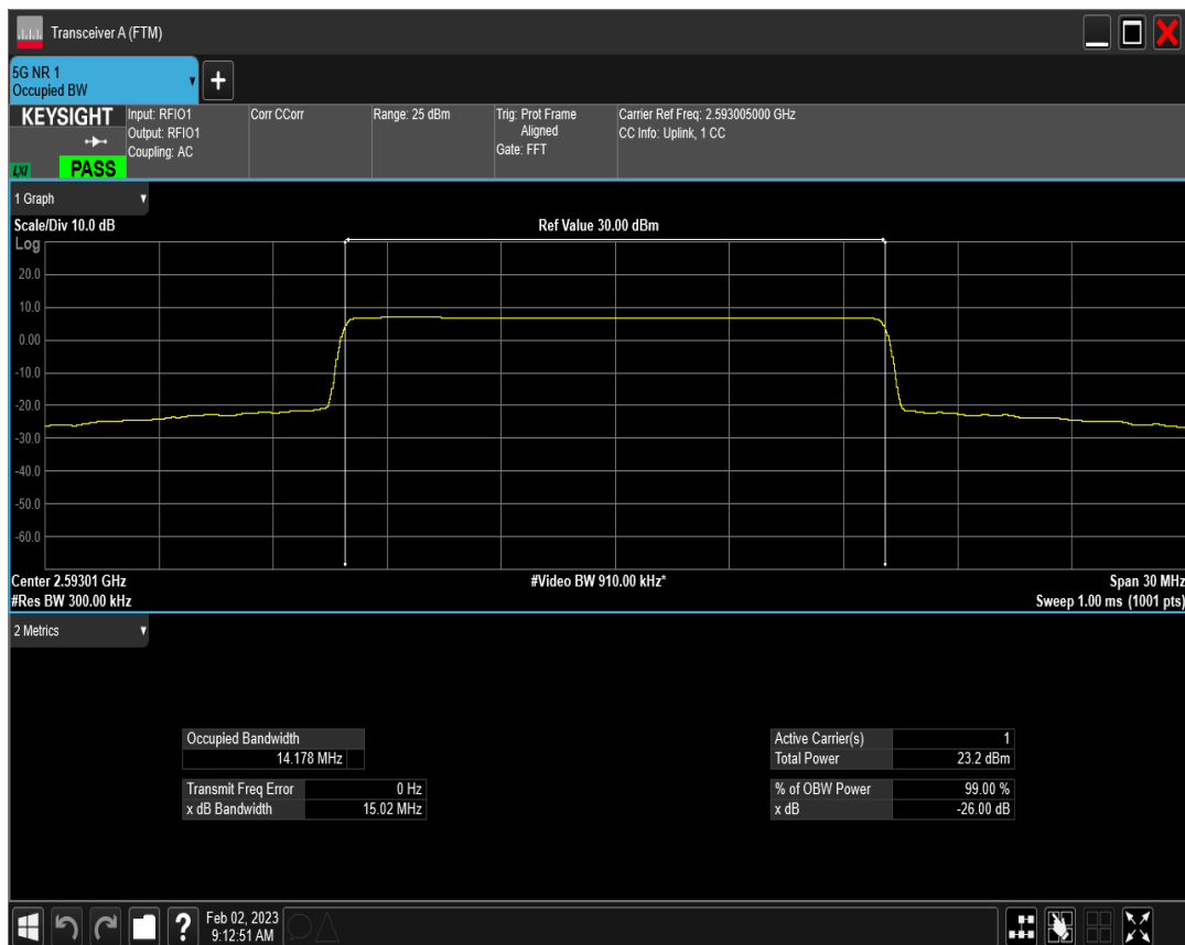
n41 SCS=15kHz DFT_BPSK BW=15MHz Channel=536499 RB=75@0
