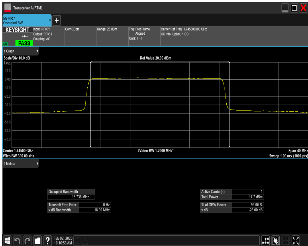
n66 SCS=15kHz DFT_QAM256 BW=20MHz Channel=349000 RB=100@0
