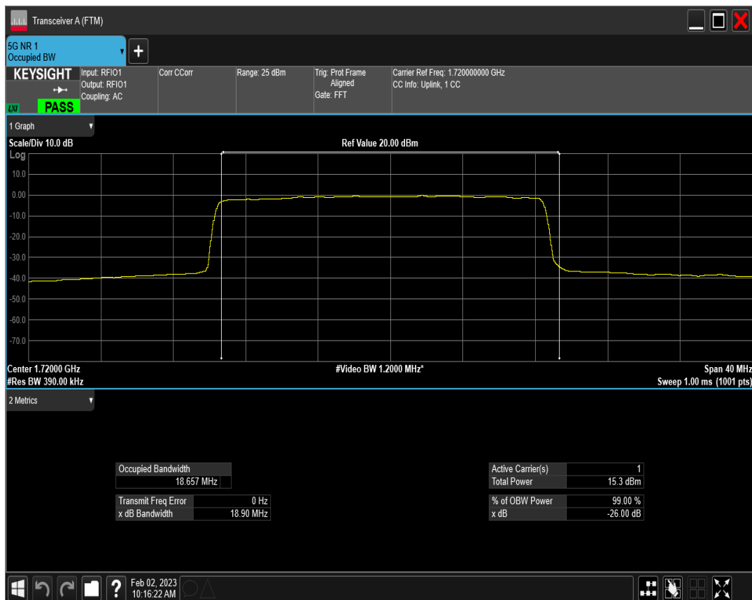
n66 SCS=15kHz CP_QPSK BW=20MHz Channel=344000 RB=106@0
