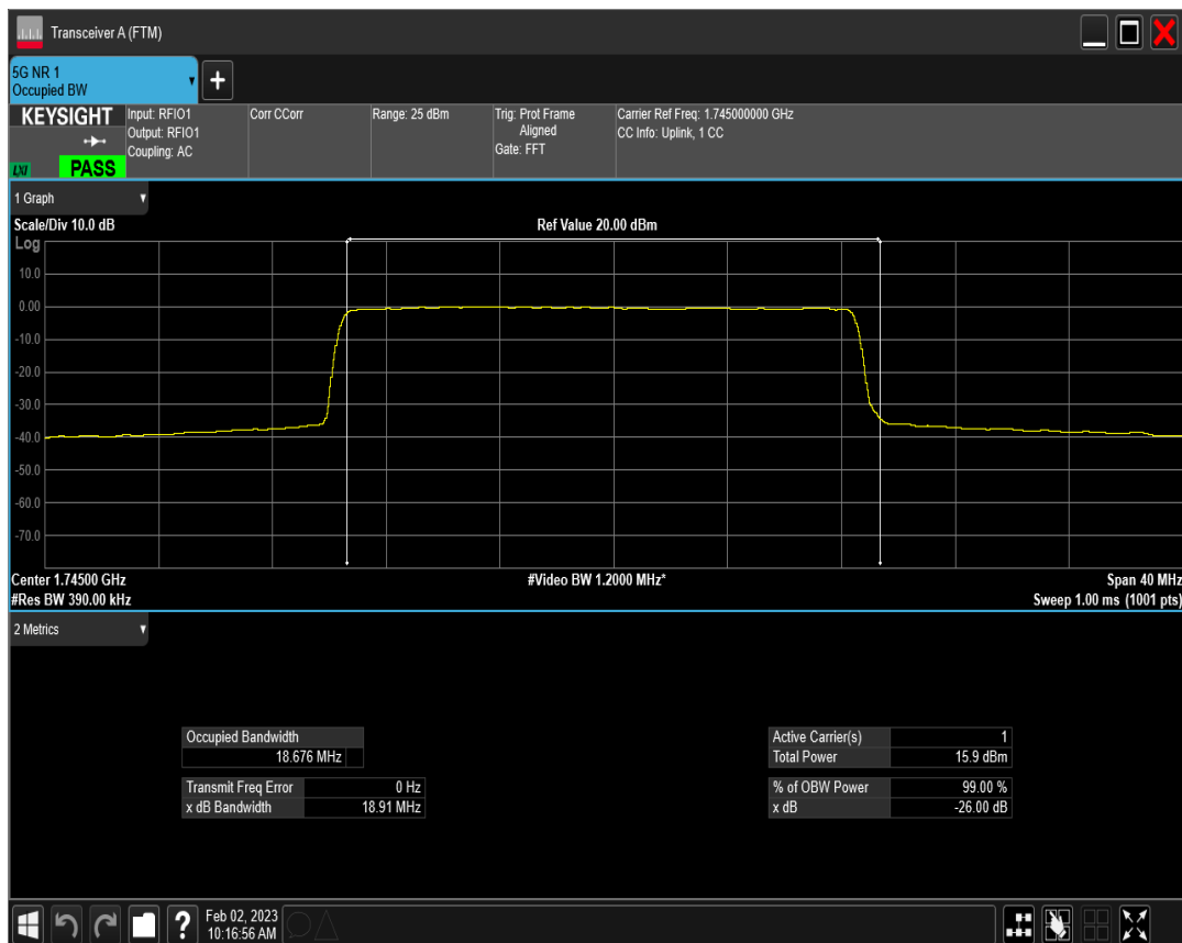
n66 SCS=15kHz CP_QPSK BW=20MHz Channel=349000 RB=106@0
