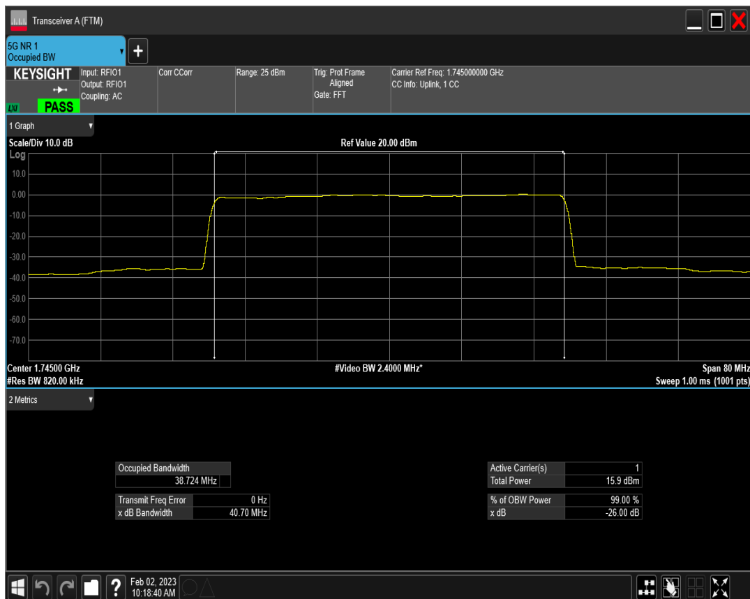
n66 SCS=15kHz CP_QPSK BW=40MHz Channel=349000 RB=216@0
