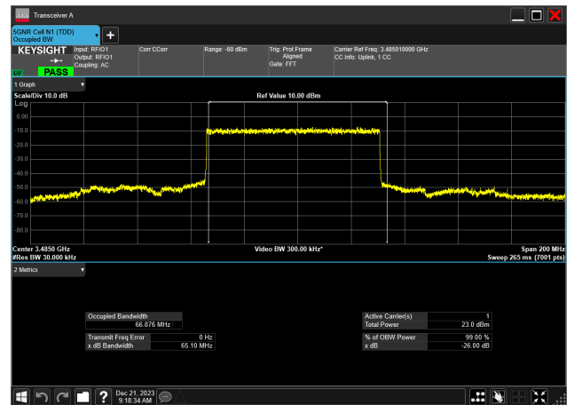
70MHz_30kHz_3485MHz_DFT-s-OFDM PI/2 BPSK_RB180@0 66.876 MHz
